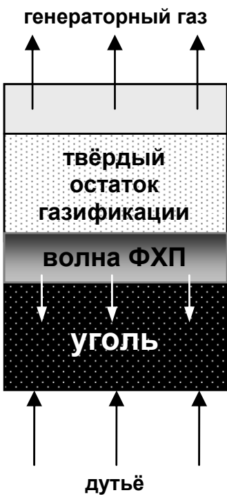
Рисунок 2 – Схема процесса слоевой газификации с обращённым дутьём
