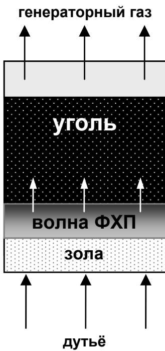
Рисунок 1 – Схема процесса слоевой газификации с прямым дутьём
