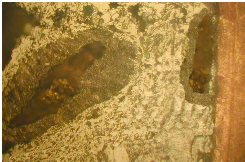
Рисунок 12 – Микроструктура композиционного припоя с двухфракционным наполнителем \times 1000
