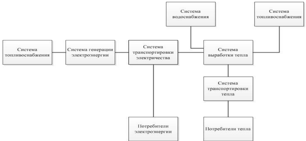
Рисунок 4 - Функциональная схема системы энергоснабжения
