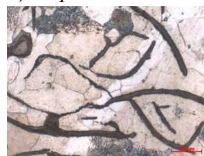
Зона перлита между поверхностным слоем и центральной зоной отливки
