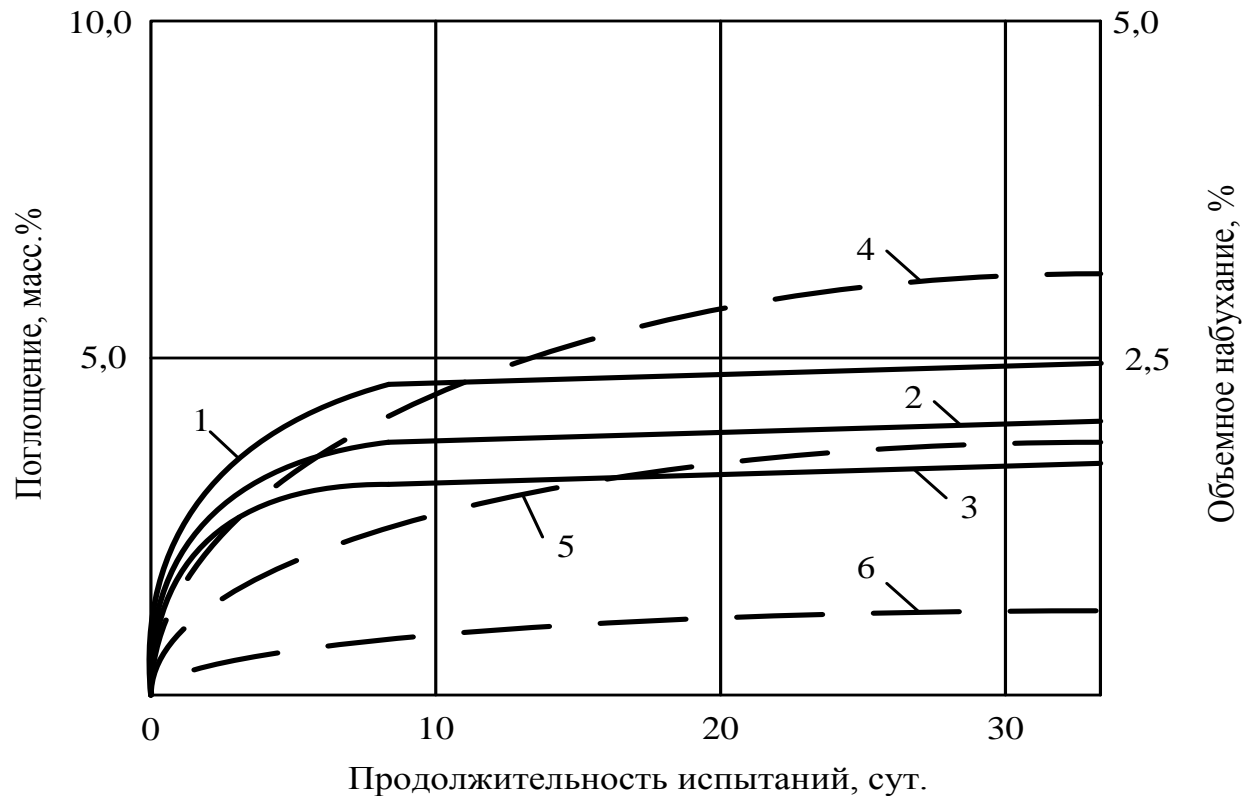
Рис. 5. Поглощение (1, 2, 3) и набухание (4, 5, 6) защитного покрытия толщиной 3 мм в 30-ти суточном возрасте при вымачивании в агрессивной среде при содержании лигнина (масс. %): 1, 2 – 3,0; 3, 4 – 6,0; 5, 6 – 9,0
