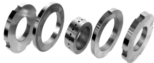
Рис. 19 – Экспериментальный шпиндельный узел и детали адаптивной гидростатической опоры с встроенным плавающим кольцевым регулятором
