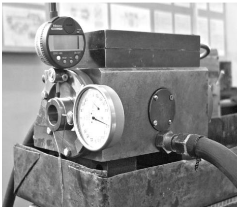
Рис. 19 – Экспериментальный шпиндельный узел и детали адаптивной гидростатической опоры с встроенным плавающим кольцевым регулятором
