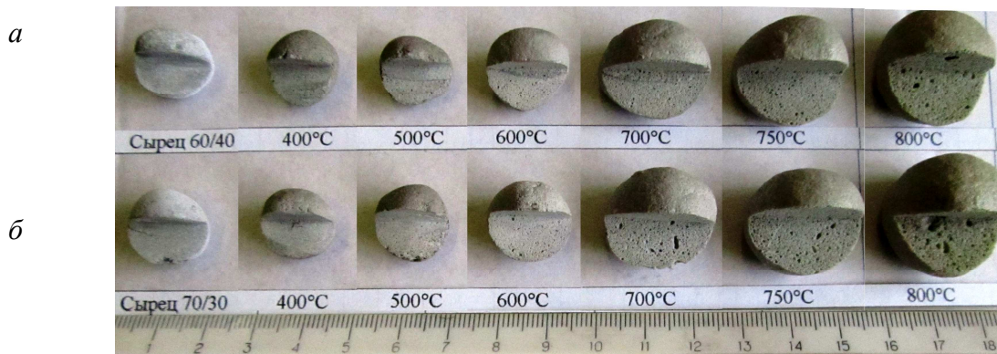
Рис. 5. Изменение объема и пористости гранул из композиций стеклобоя с добавкой 40 % (а) и 30 % (б) высококальциевого шлака в зависимости от температуры обжига
