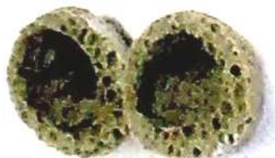
Рис. 10. Полая гранула из композиции стеклобой (60 %) и шлака (40 %) в разрезе
