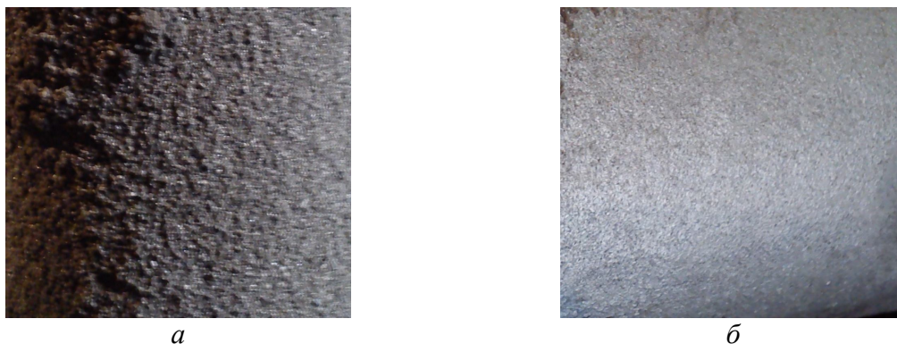
Рис. 10. Качество поверхности отливки, изготовленной без применения покрытия (а) и с применением покрытия на основе графита ГЛС-2ОА (б)
