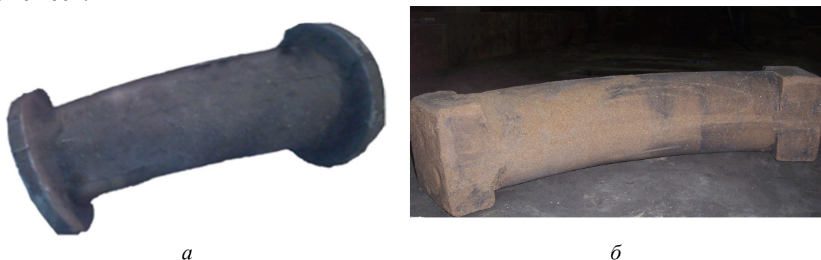
Рис. 9. Отвод для пневмотрасс L45^\circ : а – отливка, полученная с применением стержня, окрашенного покрытием на основе окисленного активированного графита; б – стержень
