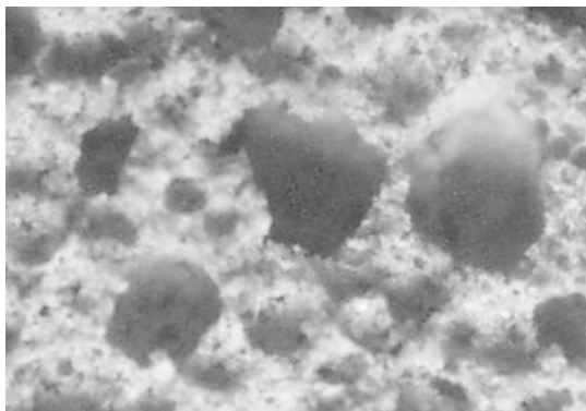
Рис. 3. Микрофотография структуры пористой строительной керамики состава 1
