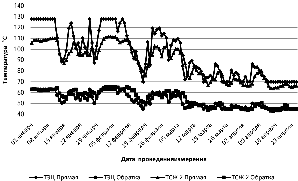
Рисунок 5 – Температура теплоносителя на Красноярской ТЭЦ-3 в сравнении с температурой ТСЖ 2, к.п.д.– 0.78
