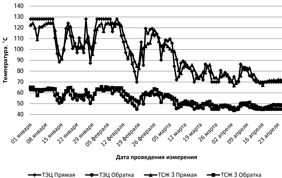
Рисунок 6 – Температура теплоносителя на Красноярской ТЭЦ-3 в сравнении с температурой ТСЖ 3, к.п.д.– 0.95
