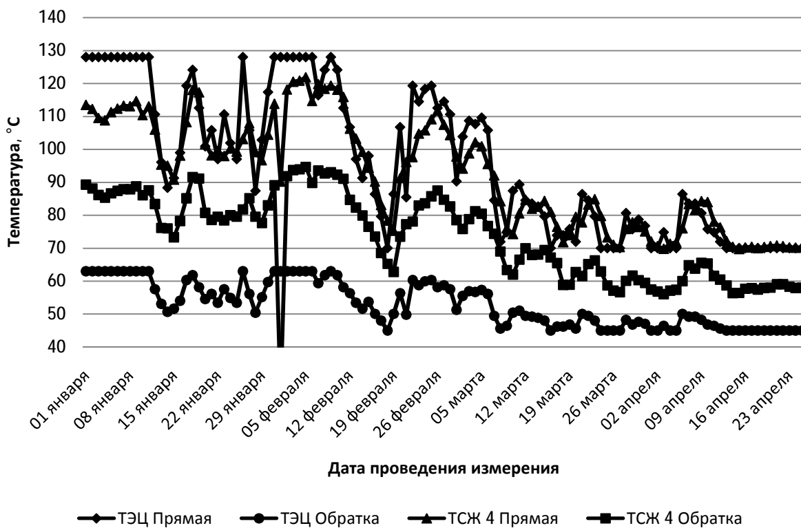
Рисунок 7 – Температура теплоносителя на Красноярской ТЭЦ-3 в сравнении с температурой ТСЖ 4, к.п.д.– 0.44
