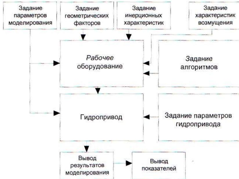
Рис.1. Структура обобщенной математической модели
