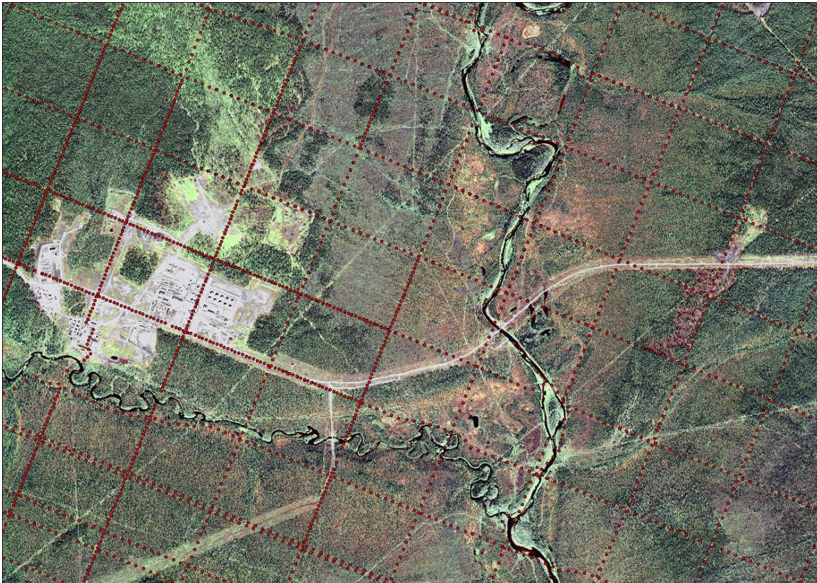
Рис. 1 - Фрагмент ортофотоплана, созданного на основе обработки материалов космической съемки высокого разрешения по разработанной методике (точками отмечены пикеты сейсмических профилей, использовавшиеся в качестве исходной основы для ортотрансформирования космоснимка
