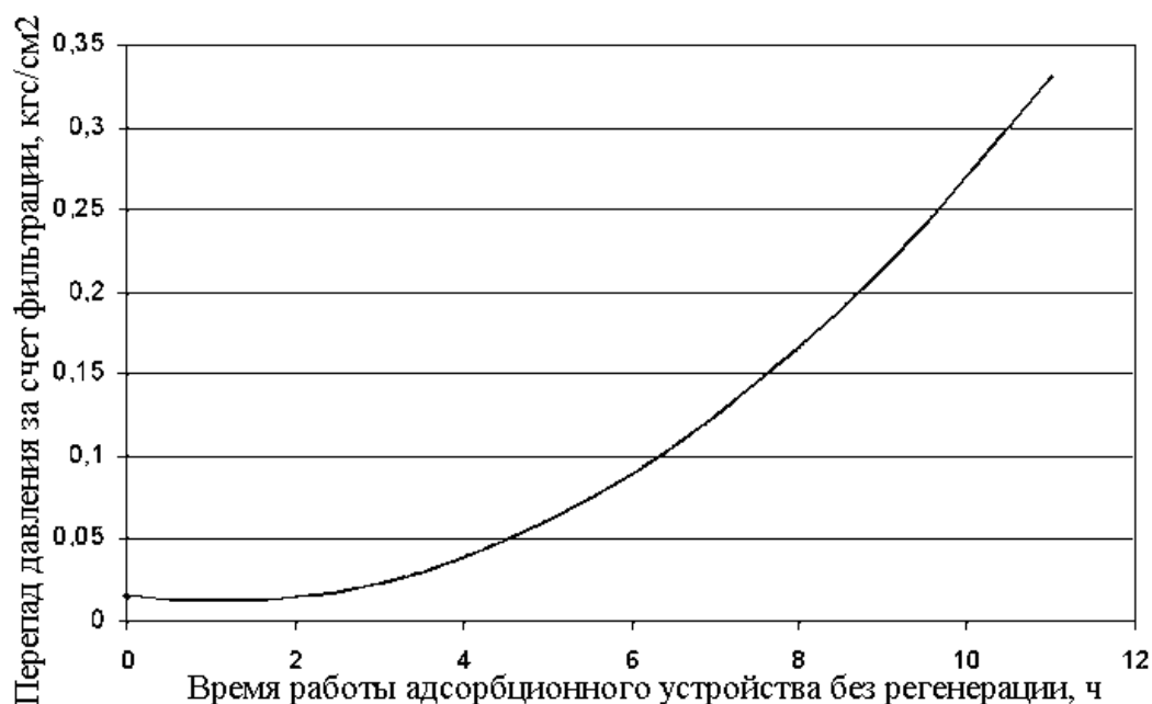
Рис. 4. График для определения максимального перепада давления за счет фильтрации
