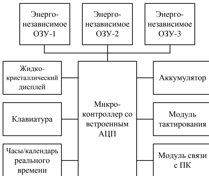
Рисунок 3 – Функциональная схема микропроцессорного модуля управления
