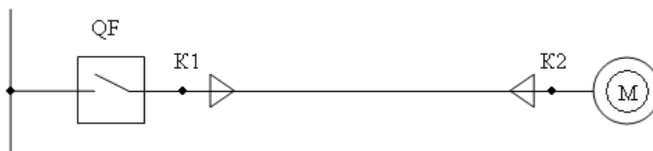
Рисунок 6 - Расчетная схема для определения кратностей коммутационных перенапряжений
