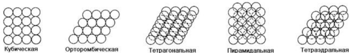
Рисунок 1.3 – Геометрические модели возможных типов плотной упаковки шаров [42,43]
