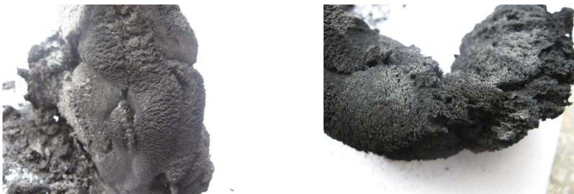
Рис. 26. Образец металлокерамического спека состава 70%об. (80%мас.Тi+20%мас.С) + 30%об. NiCr, полученный в результате проведения СВС.
