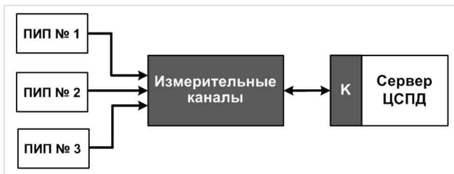
Рисунок 4.5 – Вариант построения АИИС КУЭ с реализацией функции контроллеров на сервере ЦСПД
