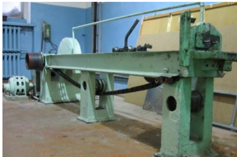
Рисунок 4.14 – Общий вид цепного волочильного стана однократного действия
