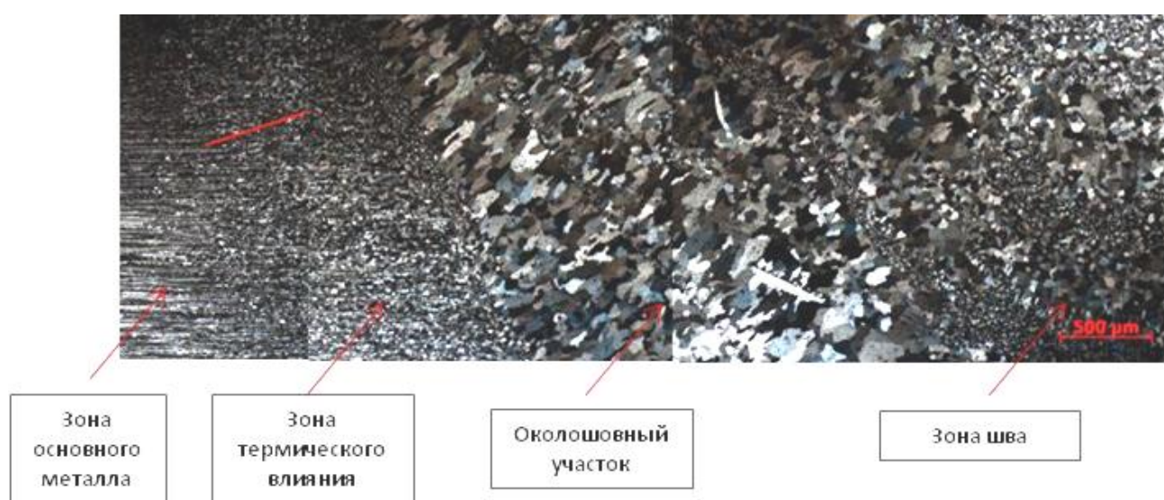
Рисунок 4.2 – Характерные зоны сварных соединений на микроструктуре образцов, \times 50
