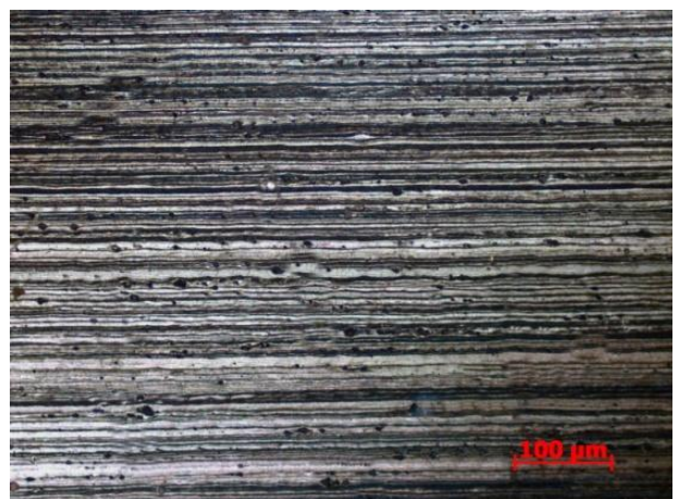
Рисунок 3.20 – Микроструктура листовых полуфабрикатов после холодной прокатки на производстве, \times 200 : a, б – толщина 4,5 мм; в, г – толщина 2,5 мм; д, е – 1,5 мм
