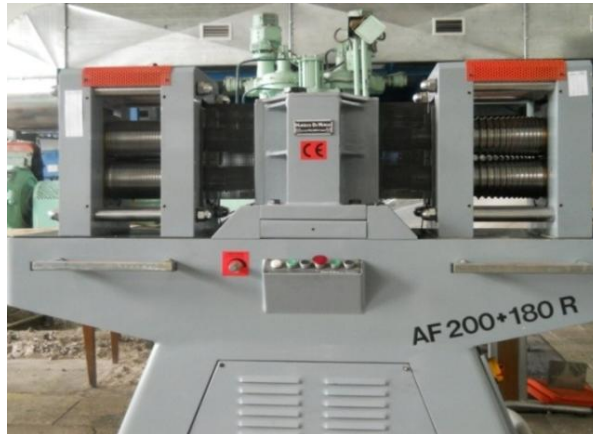
Рисунок 4.9– Общий вид сортопрокатного стана AMBIFILOVELOCEROSEN180+200
