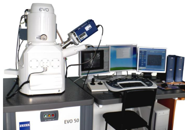
Рисунок 3.3 –Общий вид инвертированного металлографического микроскопа отраженного света Axio Observer.A1m (а)и электронный микроскоп EVO 50XVP с энергодисперсионным анализатором INCAEnergy 350 (б), CarlZeiss
