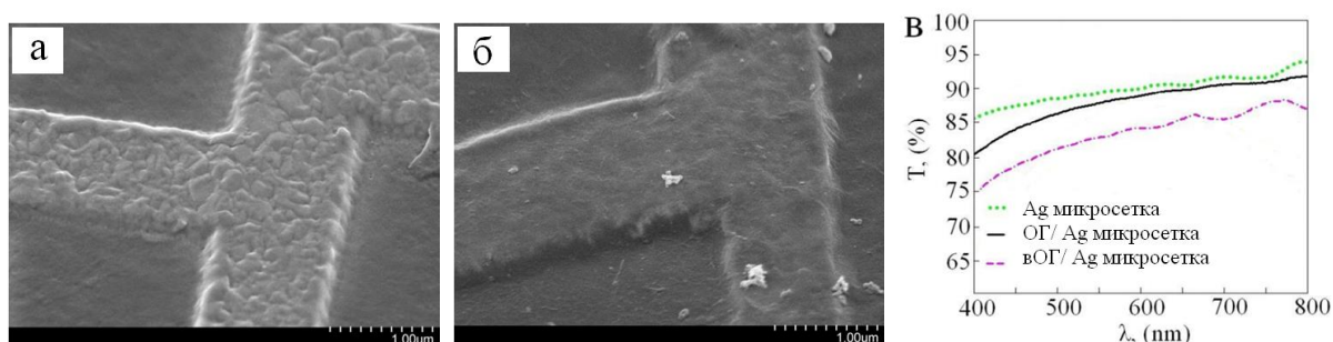
Рисунок 80 – Морфология покрытий: микросетчатого (а) и композиционного(б); оптическое пропускание композиционного покрытия на основных этапах тех. процесса (в)
