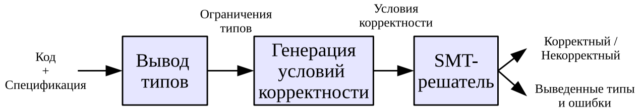
Рисунок 1.3 — Схема работы системы LiquidHaskell
