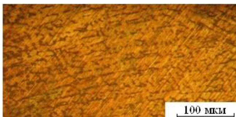
Рисунок 4.2 – Микроструктура КМ на основе меди, упрочненного дисперсными частицами TiC (x200)
