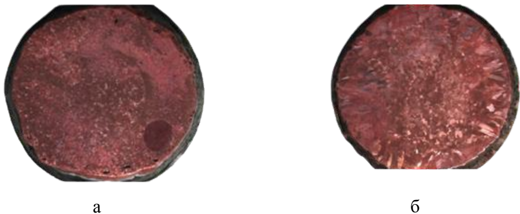
Рисунок 4.10 – Макроструктура полученных образцов (а – чистая медь; б – КМ системы Cu-CrB 2 )
