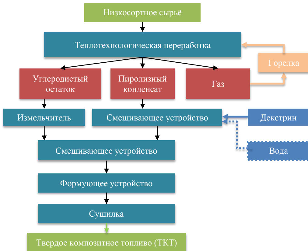
Рисунок 5.2 – Вариант принципиальной схемы производства ТКТ из полукокса и связующего на основе декстрина
