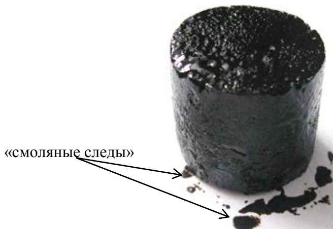
Рисунок 4.1 – ТКТ из полукокса и пиролизной смолы, высушенное при температуре 80 °С
