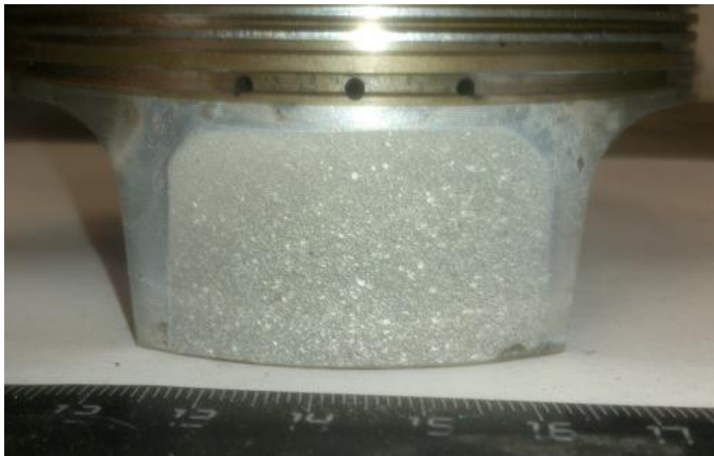
Рисунок 5.6 – Юбка поршня двигателя «Поларис» с напыленным покрытием
