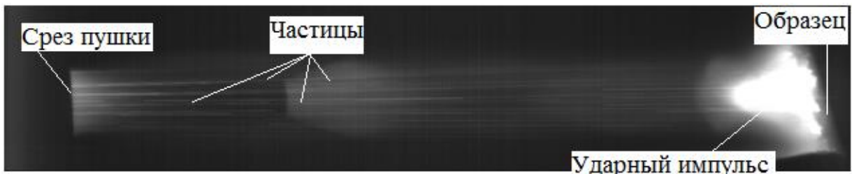
Рисунок 4.9 – Столкновение частиц напыляемого порошка с основой
