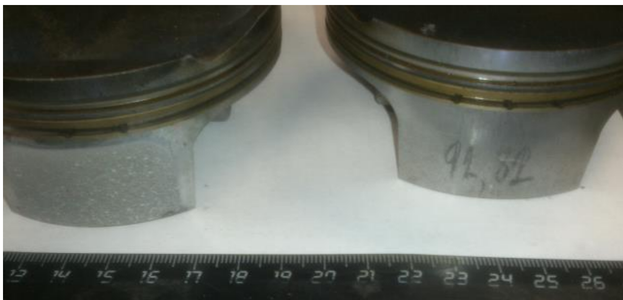
Рисунок 5.5 – Поршень двигателя «Поларис» (справа – подготовленный для восстановления, слева – с напыленным газодетонационным покрытием)
