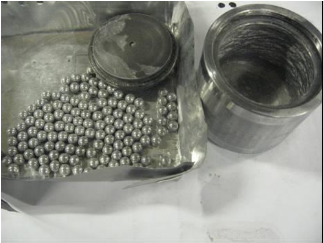
Рисунок 2.12 – Барабан активатора АГО-2С и мелющие тела, извлеченные из барабана
