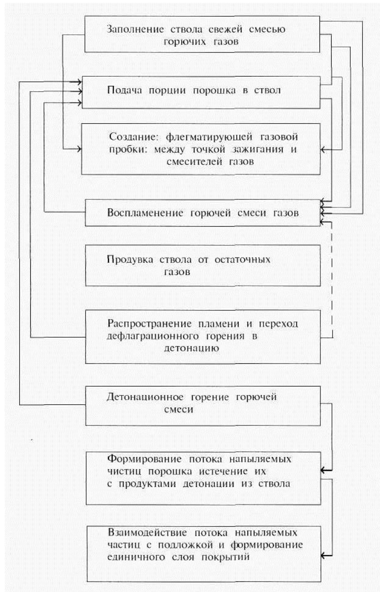
Рисунок 5.7 - Схема рабочего цикла детонационного нанесения
