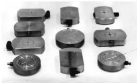
Рисунок 3.5. – Внешний вид круговых и прямоугольных газостатических опор [128]
