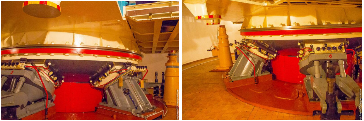
Рисунок 1.7. – Гидравлические опоры азимутального телескопа [46, 47]
