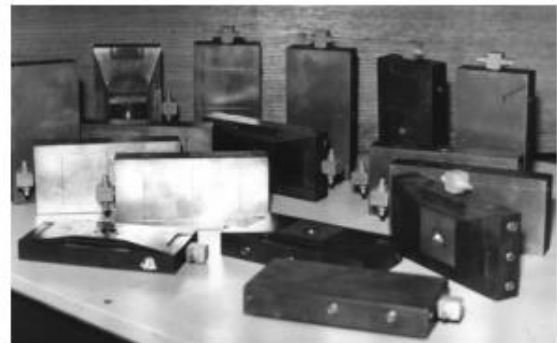
Рисунок 3.5. – Внешний вид круговых и прямоугольных газостатических опор [128]
