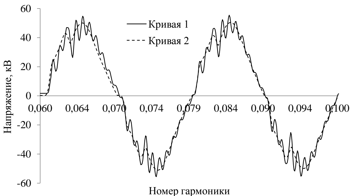
Рис. 2.38. Кривые напряжения на токоприемнике ЭПС
