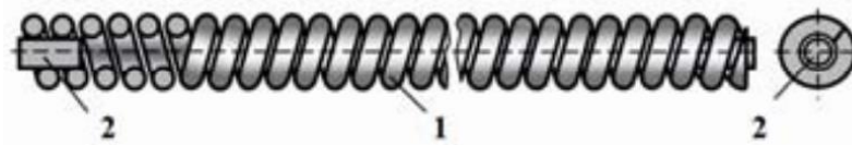
Рисунок 1.8 – Конструкция гибкой артерии: 1 – спиральная оболочка; 2 – торцевая заглушка.
