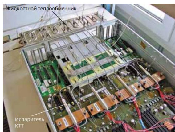
Рисунок 1.11 – Система охлаждения персонального компьютера с интегрированными КТТ
