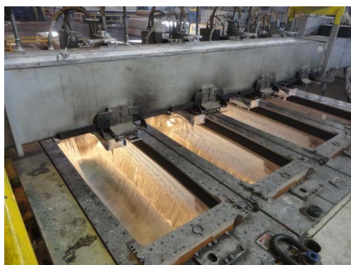
Рисунок 4.15 – Литейный стол и кристаллизатор компании Wagstaff [3]
