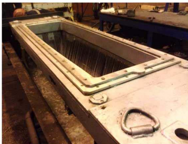
Рисунок 4.22 – Составной кристаллизатор «РУСАЛ ИТЦ» с алюминиевой вставкой
