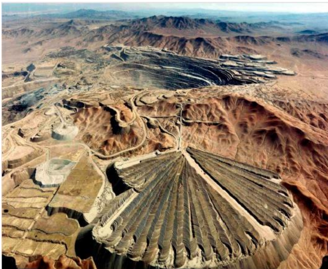
Рисунок 1.15 – Площадка складирования «сухих» отходов на золоторудном месторождении La Coipa , Атаками, Чили [70]
