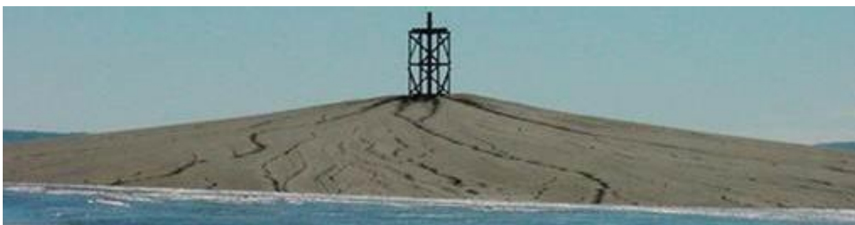
Рисунок 1.11 – Конусное складирование пастообразных отходов на отдельном полигоне, Barrick, Танзания [44]
