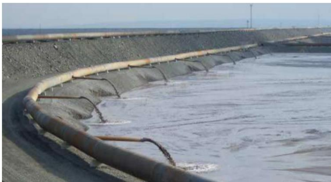
Рисунок 1.6 – Складирование пульпообразных отходов обогащения в хвостохранилище [46]
