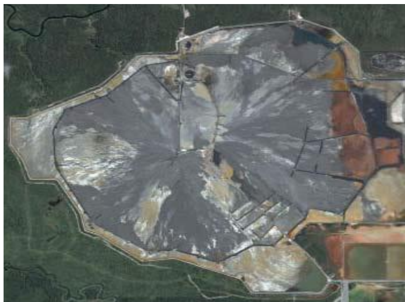
Рисунок 1.10 – Конусное складирование пастообразных отходов на фабрике Kidd Creek, Канада [50]
