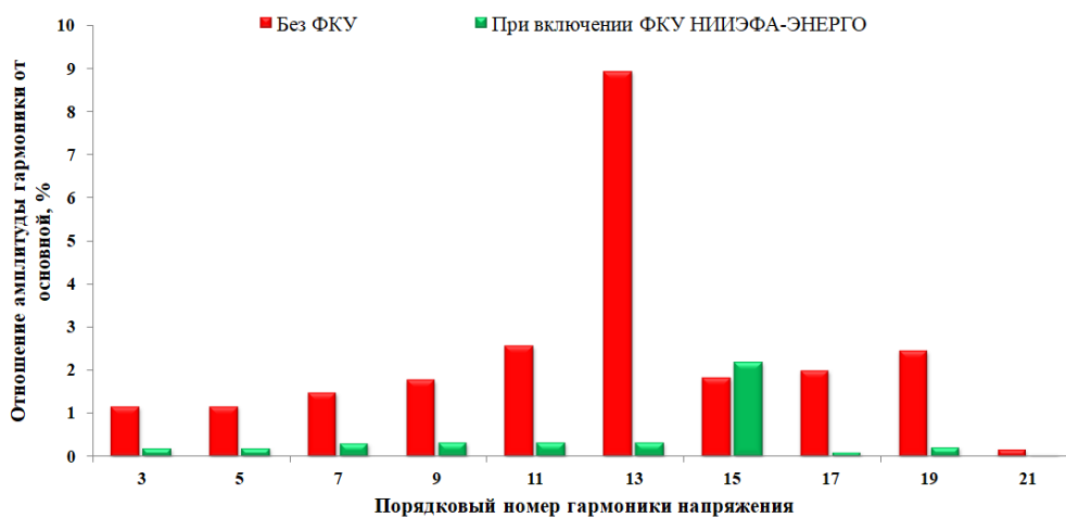
Рисунок 4.12 – Спектры напряжения на первичной обмотке тягового трансформатора
