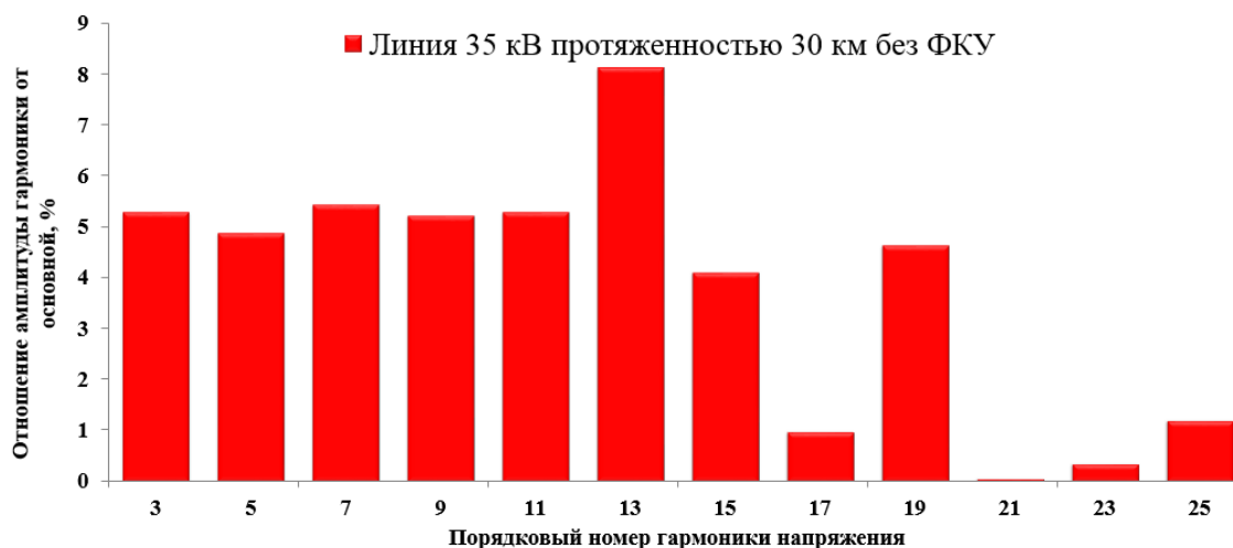
Рисунок 1.11 – Спектры напряжения на стороне линии нетягового электроснабжения 35 кВ при нахождении ЭПС на участке тяговой сети
