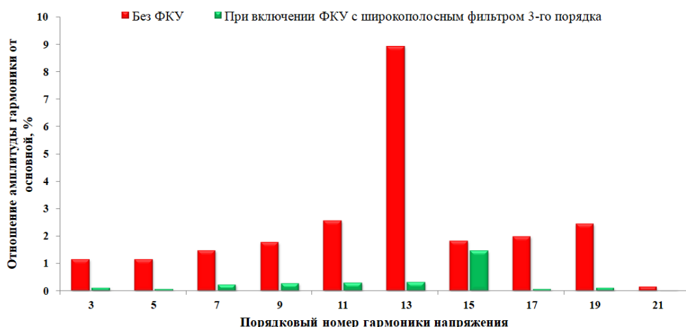
Рисунок 4.6 – Спектры напряжения на первичной обмотке тягового трансформатора
