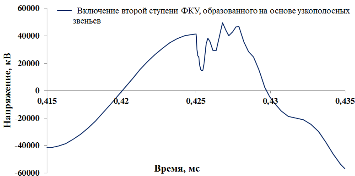
Рисунок 3.3 – Переходный процесс при включении второй ступени ФКУ на основе узкополосных звеньев (рисунок 3.1)
