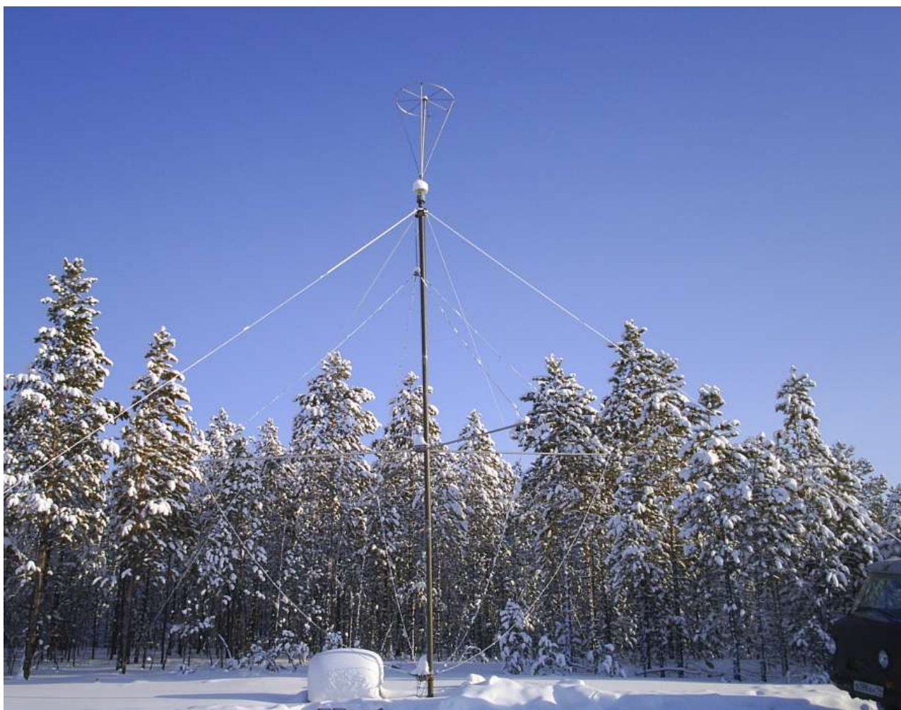
Рисунок 2.1 – Однопунктовый грозопеленгатор-дальномер ИКФИА
