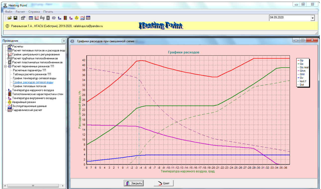
Рис. А.17. График расходов сетевой воды в условиях максимального водопотребления в СГВ в течение отопительного периода
