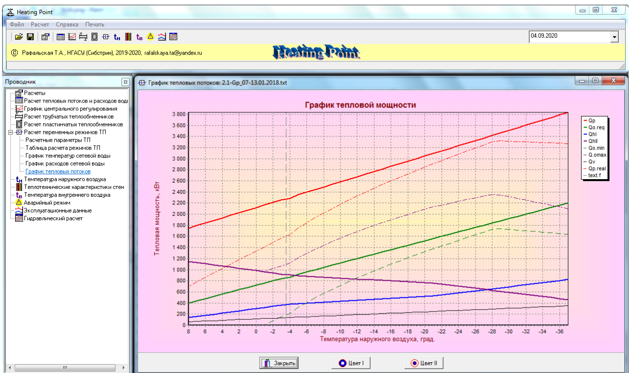
Рис. А.18. График тепловых потоков в условиях максимального водопотребления в СГВ в течение отопительного периода
