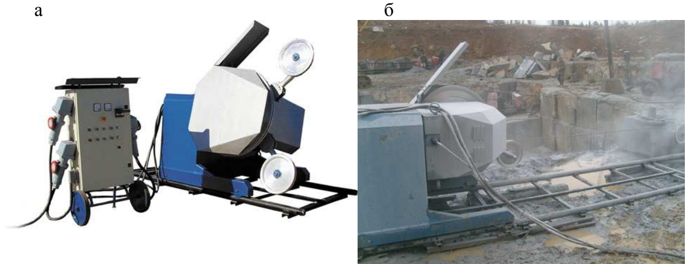
Рисунок 5.10 – Канатно-алмазная пила: а-общий вид; б – в забое
