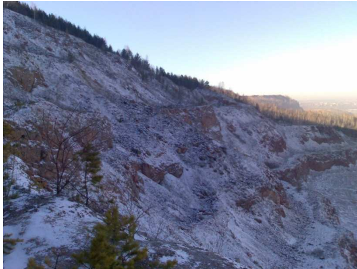
Рисунок 5.4 – Вид борта известнякового карьера при производстве буровзрывных работ без контурной отбойки
