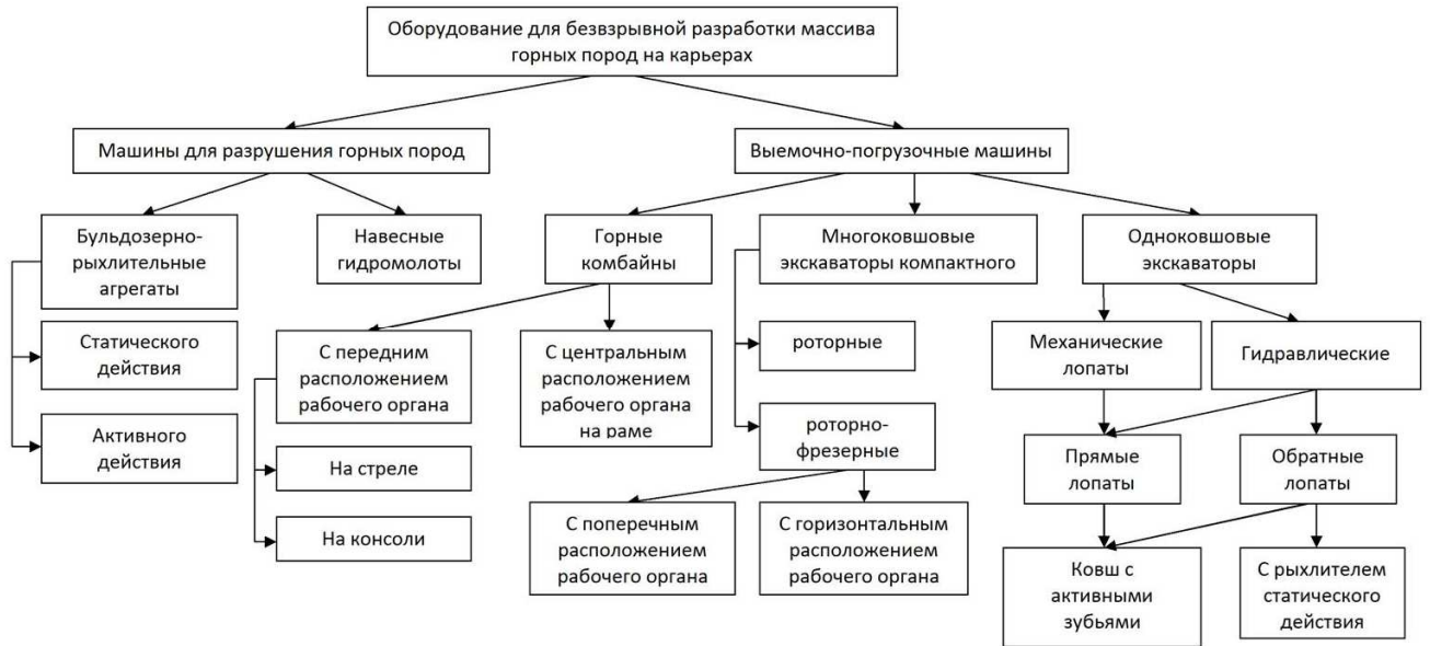
Рисунок 1.5 – Оборудование для безвзрывной разработки массива горных пород на карьерах [11]
