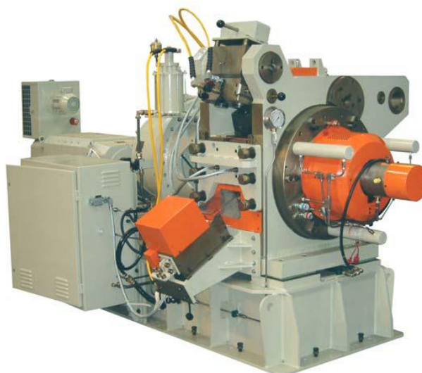
Рис. 1.6. Установка CONFORM™ 400 компании BWE Ltd [20, 21]
