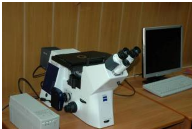
Рисунок 2.9 - Оптический микроскоп Carl Zeiss AxioObserver A1m
