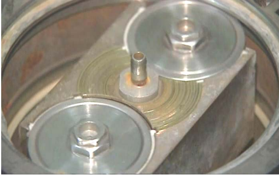
Рисунок 2.1 – Планетарная шаровая мельница АГО-2С
