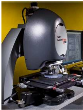
Рисунок 2.12 - Комплекс изучения топографии поверхности (оптический интерферометр) Zygo NewView™ 7300
