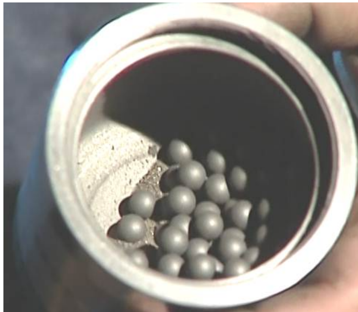
Рисунок 2.2 – Емкость (барабан) для размола со стальными шарами
