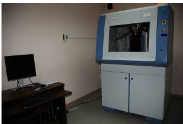
Рисунок 2.11 - Рентгеновский дифрактометр ARL X'TRA
