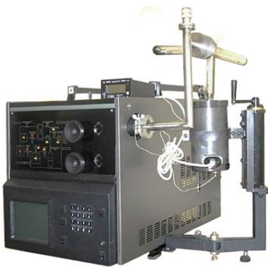
Рисунок 2.15 – Анализатор содержания водорода АВ-1 [84]
