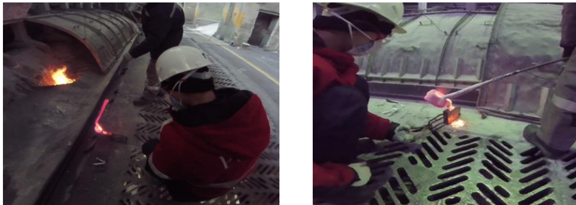
Рисунок 2.10 – Отбор проб алюминия из электролизеров [151]
