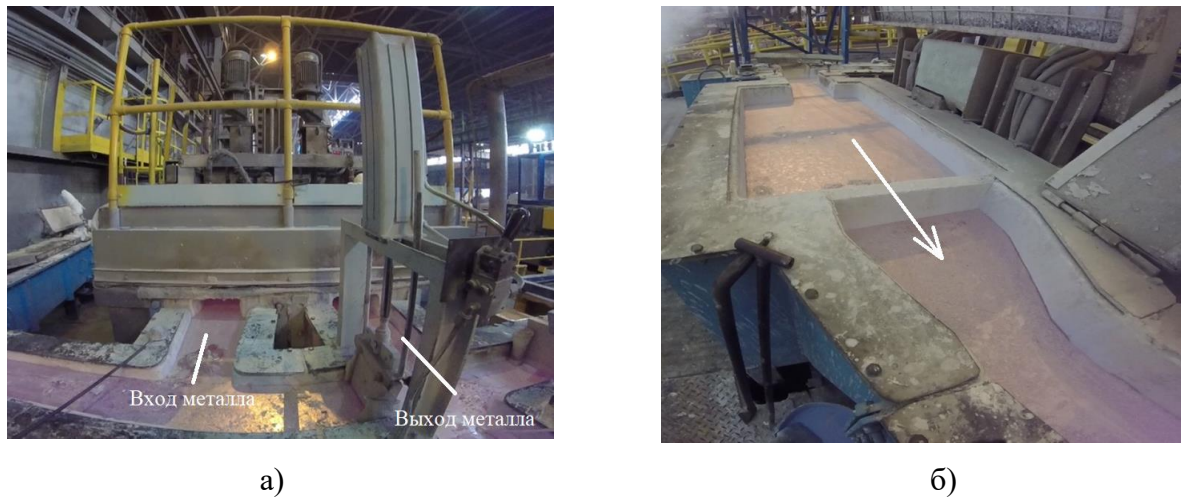
Рисунок 2.13 – Установка SNIF P-140UHB (а) и ванночка с ПКФ (б); Стрелками показано направление движения металла.
