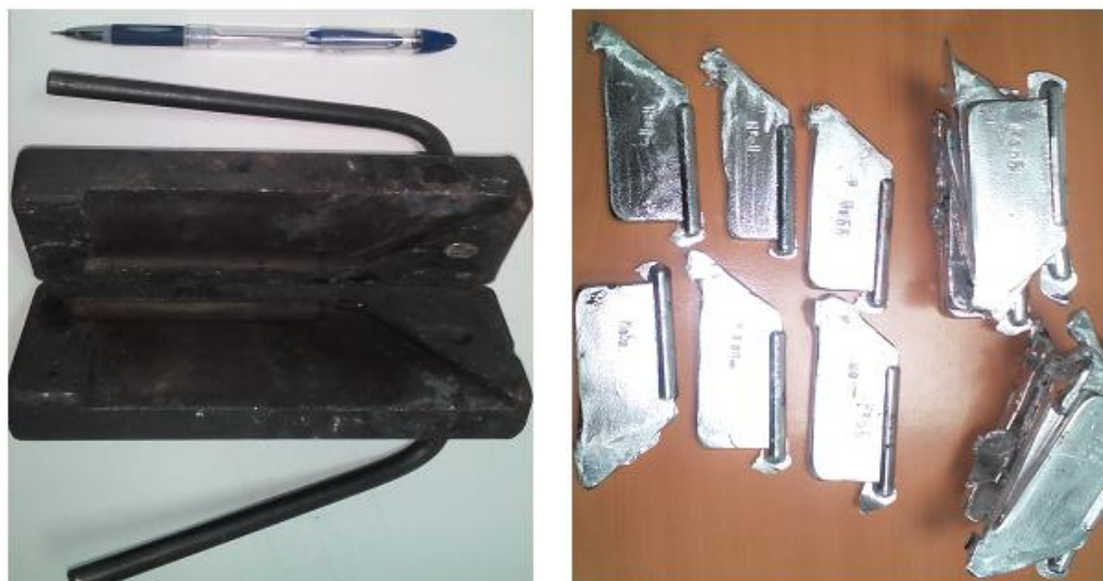
Рисунок 3.12 – Кокиль Ренсли и отливаемые в него пробы.
