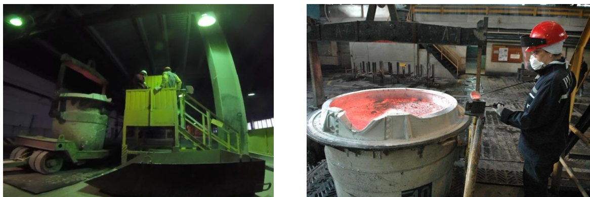
Рисунок 2.11 – Отбор проб алюминия на участке удаления шлака из ковшей
