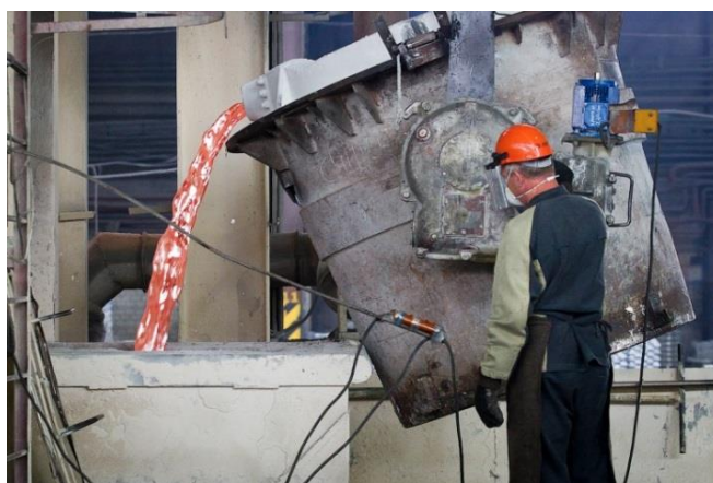
Рисунок 3.2 – Заливка расплава алюминия в миксер [151]
