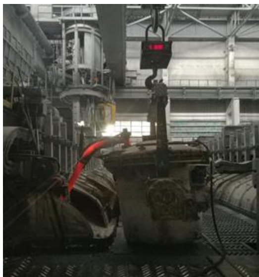
Рисунок 4.6 - Выливка алюминия из электролизера.
