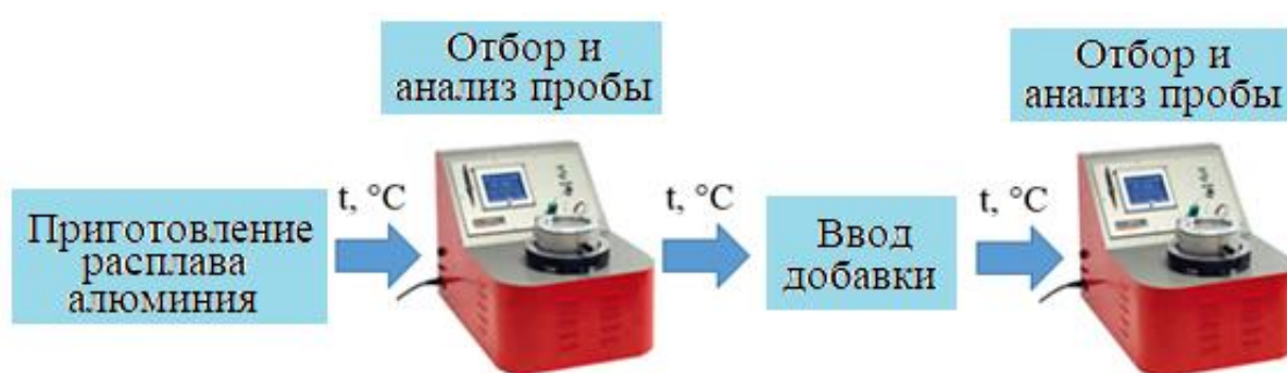
Рисунок 2.14 – Методика эксперимента по определению концентрации водорода в расплаве алюминия при вводе в него лигатур, модификаторов, флюсов [117].
