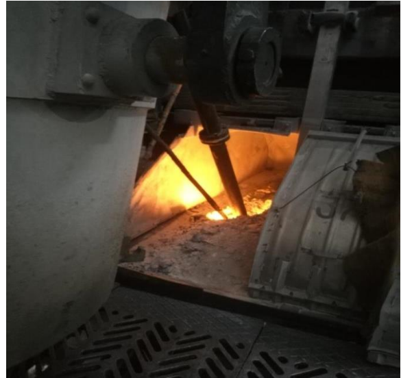
Рисунок 4.5 - Прогрев носка сифона ВТК над леткой электролизера.
