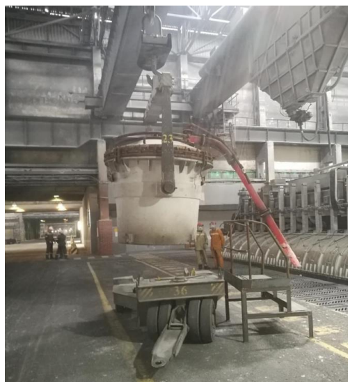
Рисунок 4.7 - Установка ковша с металлом на транспортную тележку.
