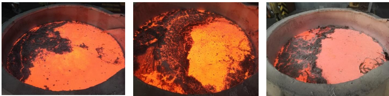
Рисунок 4.8 - Шлак на поверхности расплава алюминия в ковшах после набора металла с использованием сифона.
