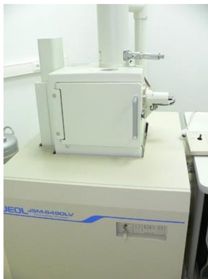
Рисунок 2.18 – Общий вид растрового электронного микроскопа JEOL JSM-6490 LV [134]
