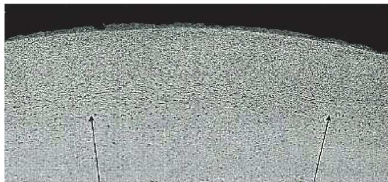
Рис. 1.10 - Структура с пористостью круглого сплошного слитка сплава 2014
