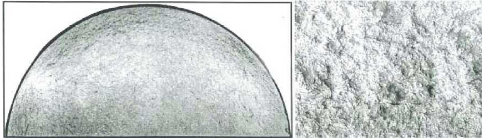
Рис. 1.11 - Подкорковая пористость в слитке
