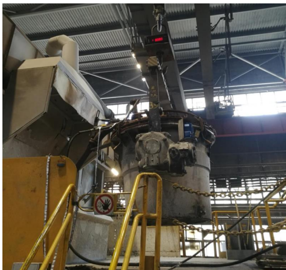
Рисунок 4.9 - Перелив алюминия из ВТК в миксер с использованием сифона.
