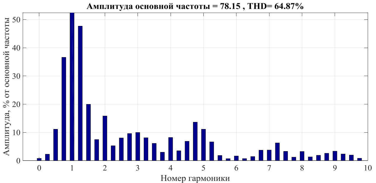
Рис. 2.50 – Быстрое преобразование Фурье спектра тока фазы С
