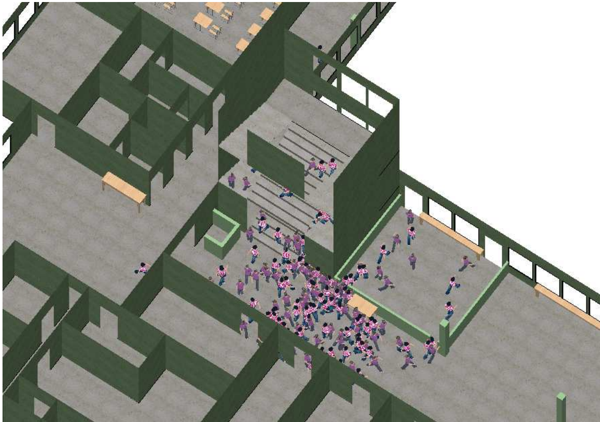
Рисунок 3.13 – Спуск по центральной лестнице на центральный выход первого этажа школы
