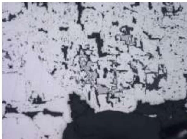
Рис. 4.44. Реликты незамещенного пирротина-II – серое, пиритом-III – белое. Черное – нерудные минералы. Месторождение Николаевское. Полированный шлиф. Ник. II. Ув.30 x .
