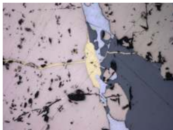
Рис. 4.29. Пирротин – слева и справа сверху пересекается микропрожилком халькопирита (желтое), сфалерита (серое) и галенита (белое). М-е Герфед. Полированный шлиф. Ник. II. Ув.80 x .
