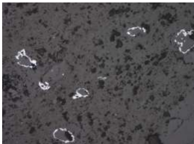
Рис. 4.36. Выделения рутила (белое) избирательно обрастают линзовидные выделения кварца в метасоматите (серое). Месторождение Герфед. Полированный шлиф. Ник.П. Ув.85 x .
