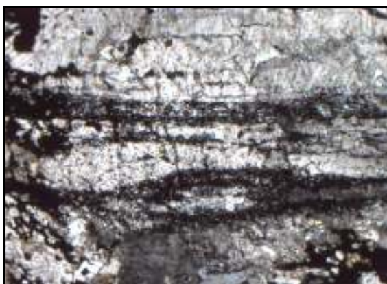
Рис. 2.11. Грубо рассланцеванная существенно альбитовая (серовато-белое) порода (аполава), черное – углеродистое вещество и рудные минералы. Месторождение Герфед. Полированный шлиф Г-8. Ник.П. Ув.25 x .
