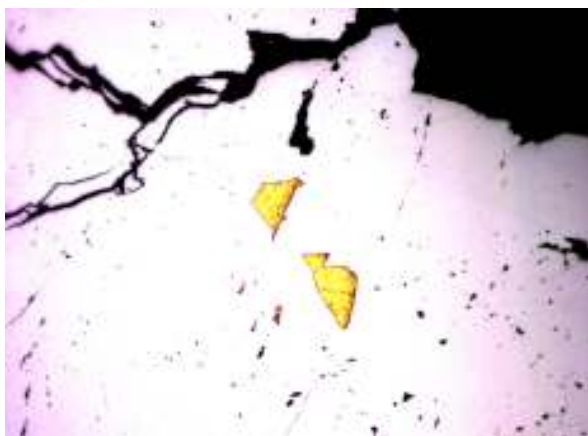
Рис. 4.24. Трещиноватый арсенипит – белое, с включениями золота – желтое. Месторождение Герфед. Полированный шлиф. Ник. II. Ув.160х.
