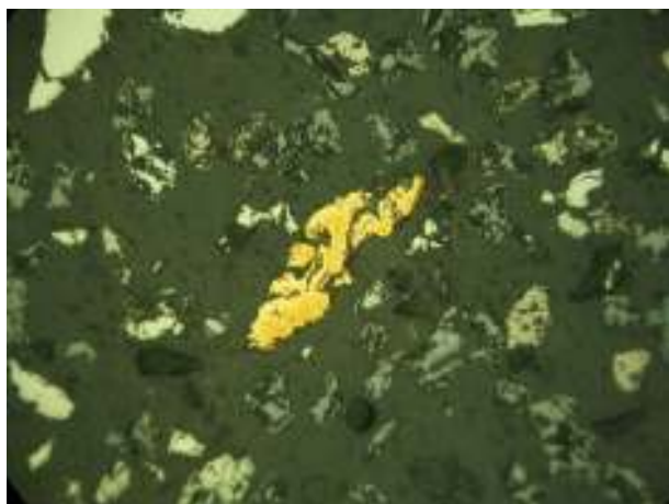
Рис. 4.59. Золото в концентрате – удлиненная сложная форма (в центре). Белое – сульфиды, серое – магнетит, темно-серое – цемент. М-е Николаевское. Искусственный полированный шлиф. Ник. II. Ув.35 x .
