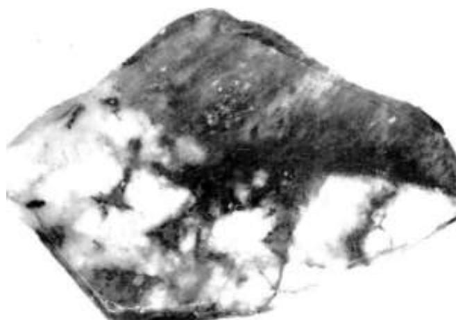
Рис. 4.4. Пятнистая текстура руды. Обособление сульфидов (серое) в белом кварце. Светло-серое – метасоматит. Жила Магистральная. Месторождение Герфед. Полированный штуф. Нат. вел.
