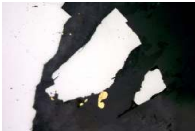
Рис. 4.41. Мелкое и тонкое свободное золото – желтое, в кварце – черное, белое – арсенипирит. Месторождение Герфед. Полированный шлиф. Ник.П. Ув.150 x .
