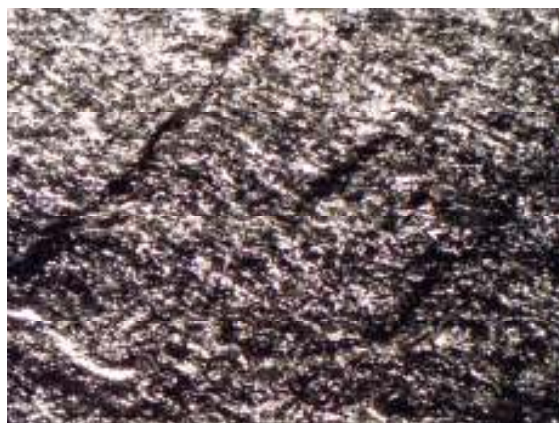
Рис. 2.14. Строение углеродистого прослоя в тонкослоистом микросланце (кординская свита). Углеродистое вещество (черное) равномерно распределено по сланцеватости, но концентрируется в просечках. М-е Герфед. Прозрачный шлиф Г 350/82,9. Ник.П. Ув.130 x
