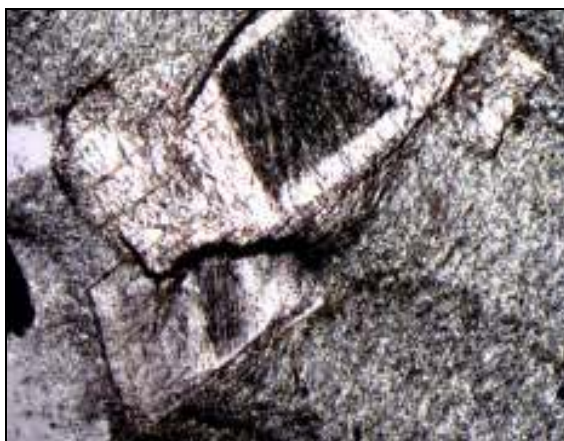
Рис. 2.9. Распределение углеродистого вещества в метакристаллах карбоната и по трещинам – черное, основная масса – серицитолит. Месторождение Герфед. Прозрачный шлиф Г 327/78,9. Ник.П. Ув.60 x .
