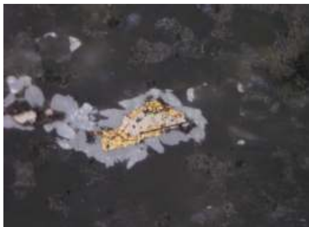
Рис. 4.35. Рутил (светло-серое) обрастает агрегат пирротина и халькопирита – в центре. Серое - метасоматит с выделениями графита. М-е Герфед. Полированный шлиф. Ник.П. Ув.170 x .
