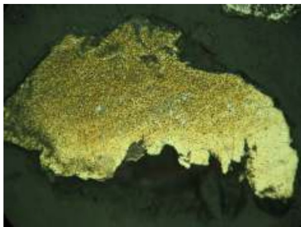
Рис. 4.60. Неоднородное строение золота – желтое. Белые включения – арсенопирит, черное – цемент. Месторождение Николаевское. Искусственный полированный шлиф. Ник. II. Ув.90 x .
