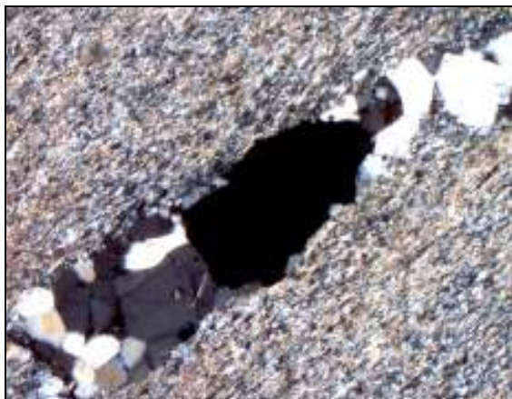
Рис. 2.7. Прожилки кварца – серо-белое в сериците – пестрое. Черное – рудный минерал. Месторождение Герфед. Прозрачный шлиф. Г 292/43,1. Ник.+. Ув.60 x .
