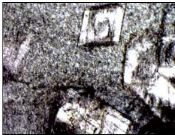
Рис. 2.8. Метакристаллы карбоната (доломит) – порфиоровые выделения в серицитолите – основная масса. Месторождение Герфед. Прозрачный шлиф Г 327/78,9. Ник.+. Ув.90 x .
