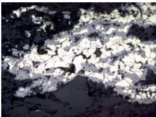
Рис. 4.45. Обрастание пирротина-I – желто-белое, рутилом – серое, черное – нерудные минералы. Месторождение Николаевское. Полированный шлиф. Ник. II. Ув.30 x .
