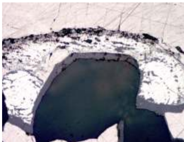
Рис. 4.34. Марказит белое, на границе с пирротинномверху и карбонатом – серое. Черное – кварц. М-е Герфед. Полированный шлиф Г 350/117,6.1. Ник.П. Ув.110 x
