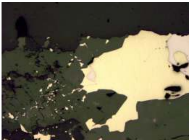
Рис. 4.53. Халькопирит – желтое в карбонатном прожилке – темно-серое в центре, серовато-белое – пирротин, черное – кварц. М-е Николаевское. Полированный шлиф. Ник. II. Ув.130 x .
