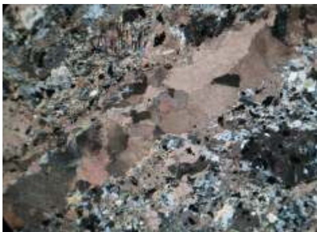
Рис. 4.15. Прожилки хлорита в рудном метасоматите. Мелкозернистый кварц – серое и белое, мусковит – цветное пестрое, рудные минералы – черное. Месторождение Николаевское. Прозрачный шлиф. Ник.+ Ув.35 x .
