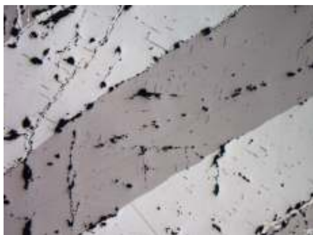
Рис. 4.25 Зональный метакристалл арсенипитита с ситовидным внутренним строением, обрастается карбонатом серое и пиритом III – желтое (вверху). М-е Герфед. Полированный шлиф. Ник. II. Ув.80х
