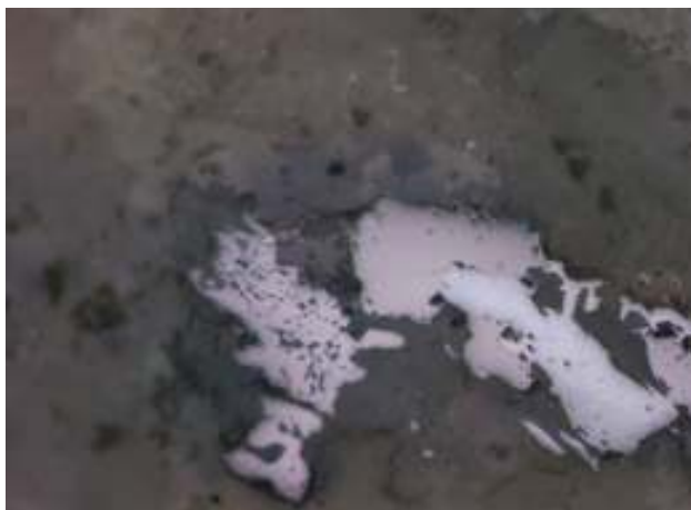
Рис. 4.51. Замещение ильменита – серое, рутилом – серо-белое, темно-серое – нерудные минералы. М-е Николаевское. Полированный шлиф. Ник. II. Ув.35 x .
