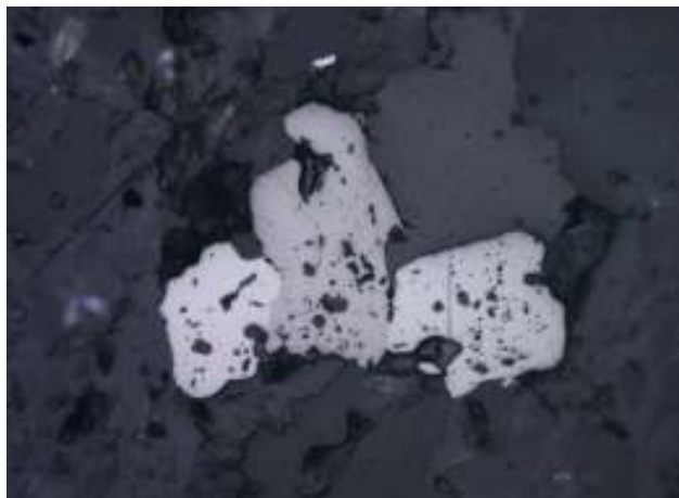
Рис. 4.50. Сrostок зерен ильменита – серое в центре и магнетита – серо-белое, темно-серое – нерудные минералы. М-е Николаевское. Полированный шлиф. Ник. II. Ув.35 x .
