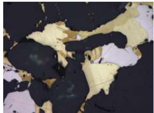
Рис. 4.54. Внутреннее строение агрегата халькопирита – желтое, серовато-белое – пирротин II. Месторождение Николаевское. Полированный шлиф. Протравлено. Ник. II. Ув.120 x .
