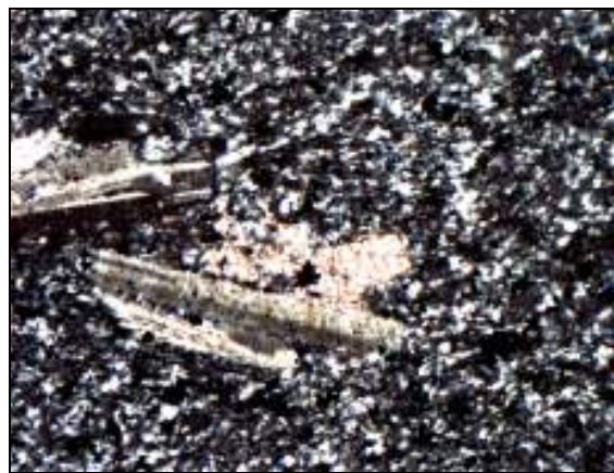
Рис. 2.10. Реликты альбитового состава порфиорового облика в хлоритизированном метавулканите (основная масса) пенченгинской свиты. Месторождение Герфед. Прозрачный шлиф Г 449/36.3. Ник.П. Ув.42 x .
