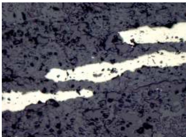
Рис. 4.43. Кулисообразное размещение агрегатов пирротина – желто-белое во внутренних зонах метасоматоза. Темно-серое – нерудные минералы. М-е Николаевское. Полированный шлиф. Ник. II. Ув.30 x .
