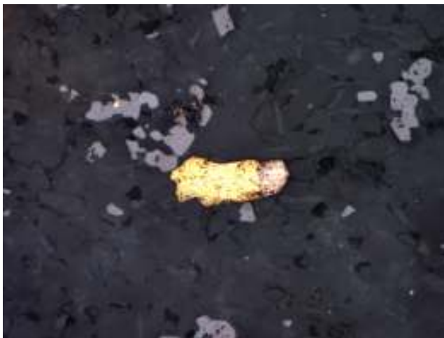
Рис. 4.40. Золото (желтое) в сростании с пиротином (серовато-белое). Серое – рутил, черное метасоматит. Месторождение Герфед. Полированный шлиф. Ник.П. Ув.165 x .
