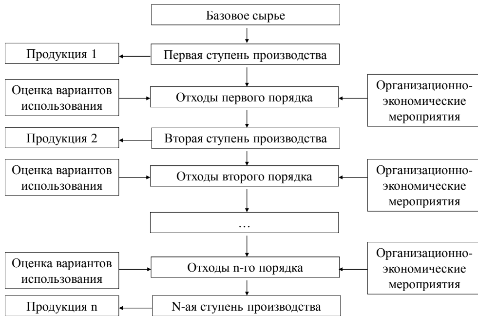
Рисунок 1.12 – Схема организации многостадийной переработки вторичных древесных ресурсов
