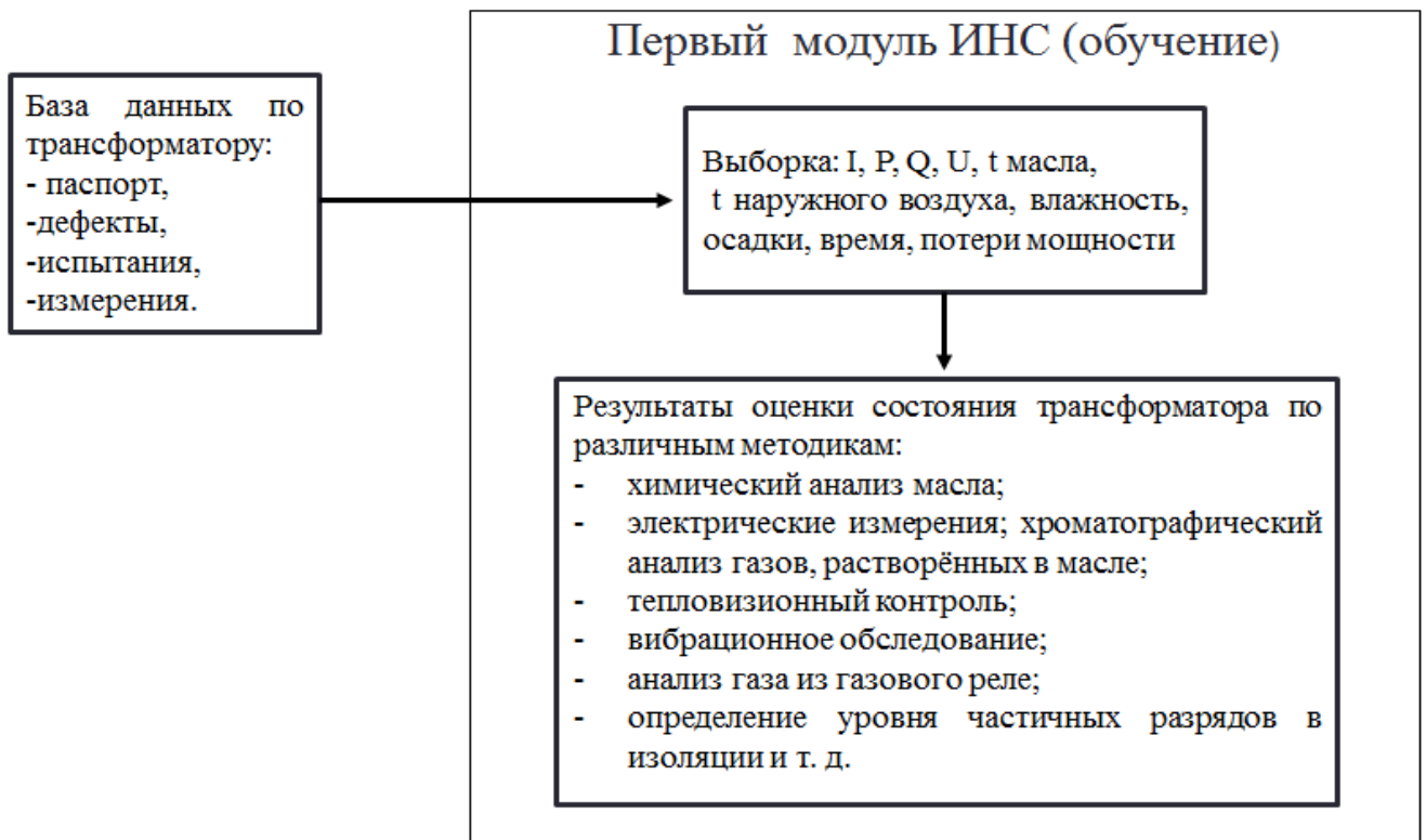
Рисунок 3.3 – Модуль диагностирования неисправностей трансформатора
