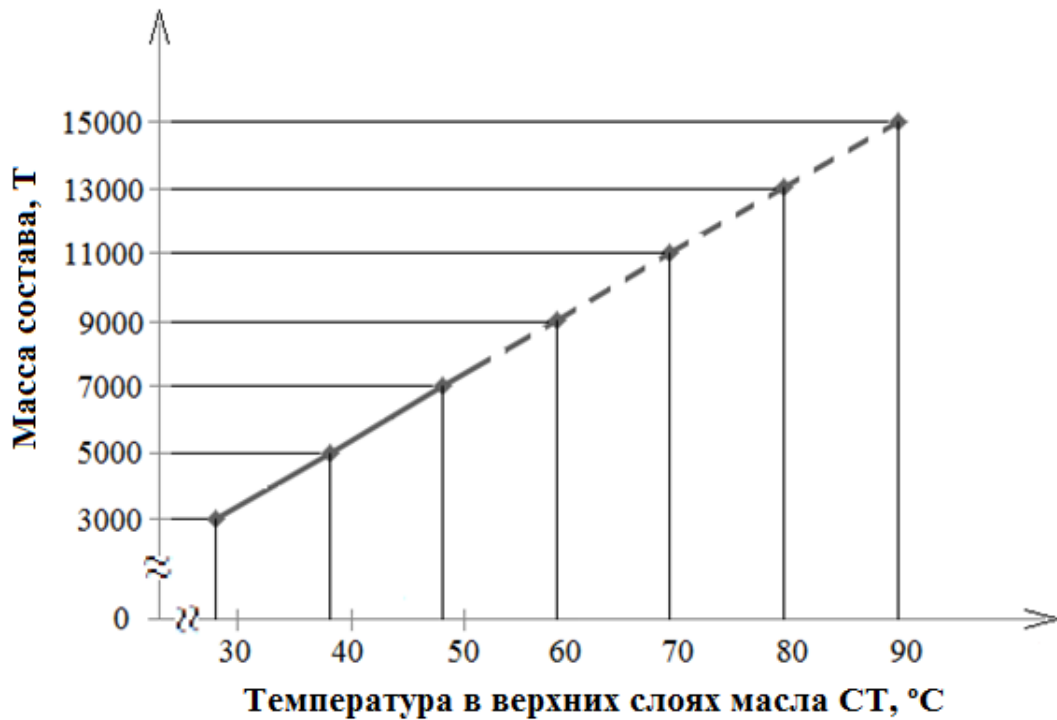
Рисунок 3.11 – Изменение температуры масла в баке трансформатора от массы состава
