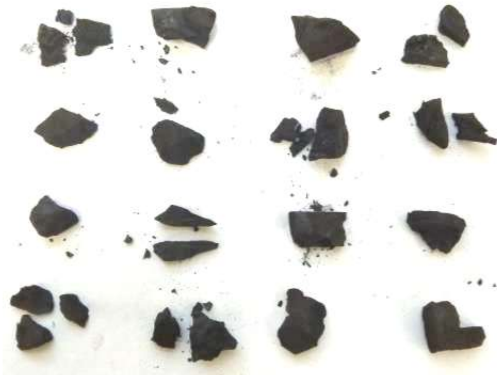
Рисунок 81 – Образцы ПКВД–2 (сверху) и угля марки 2Б (снизу) после выдержки на воздухе в течение двух месяцев
