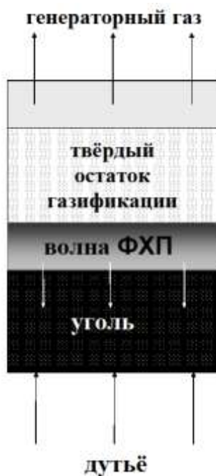
Рисунок 12 – Схема процесса слоевой газификации с обращённым дутьём
