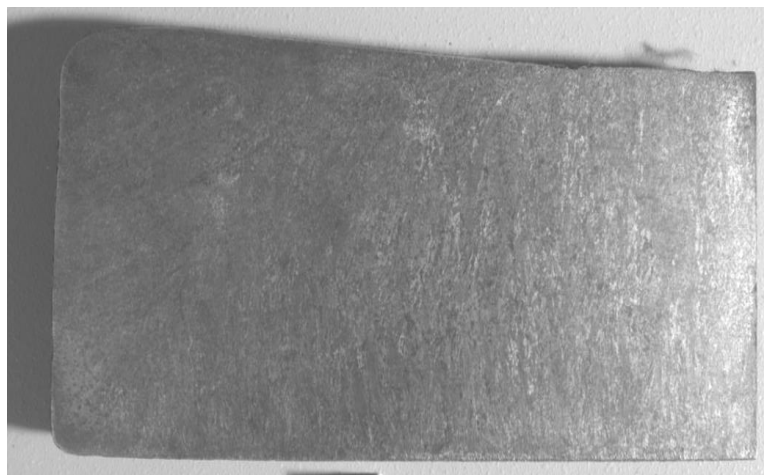
Рисунок 4.7 – Макроструктура отливок, полученных при разном распределении температурных полей: a – толщина донной части – 120 мм, верхнего шлакового слоя – 60 мм; б – то же с принудительным охлаждением донной части; в – толщина донной части 60 мм, верхнего шлакового слоя – 20 мм
