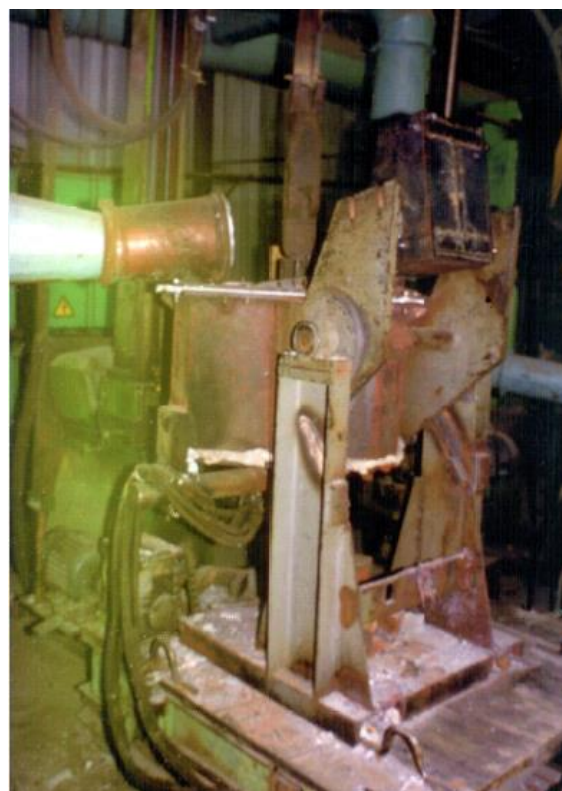
Рисунок 2.1 – Печь электрошлакового кокильного литья
