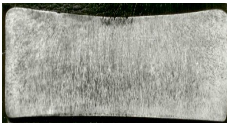
Рисунок 3.1 – Макроструктура отливки из стали 4Х5МФС (осевой разрез)
