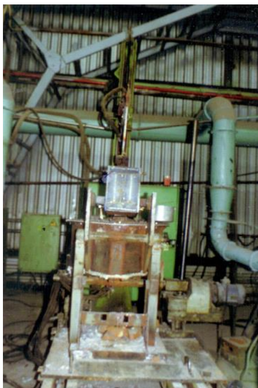
Рисунок 2.1 – Печь электрошлакового кокильного литья
