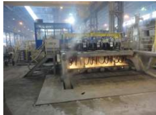
Рисунок 1.7 – Типовой литейный стол с установленными кристаллизаторами
