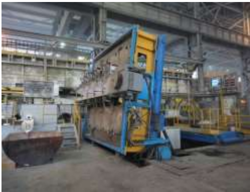
Рисунок 1.7 – Типовой литейный стол с установленными кристаллизаторами
