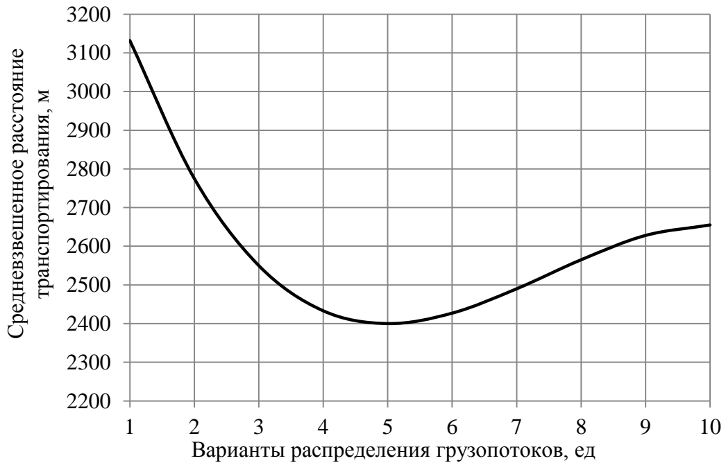
Рисунок 4.9 – График изменения средневзвешенного расстояния транспортирования от вариантов распределения грузопотоков
