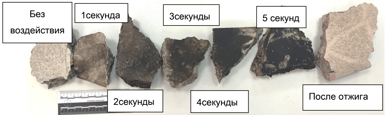
Рисунок 3.43 – Вид образцов бетона с копотью после исследований
