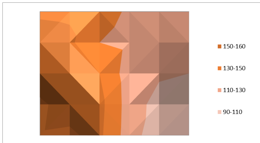
Рисунок 4.4 – Карта зон термических поражений бетонной конструкции ультразвуковым методом
