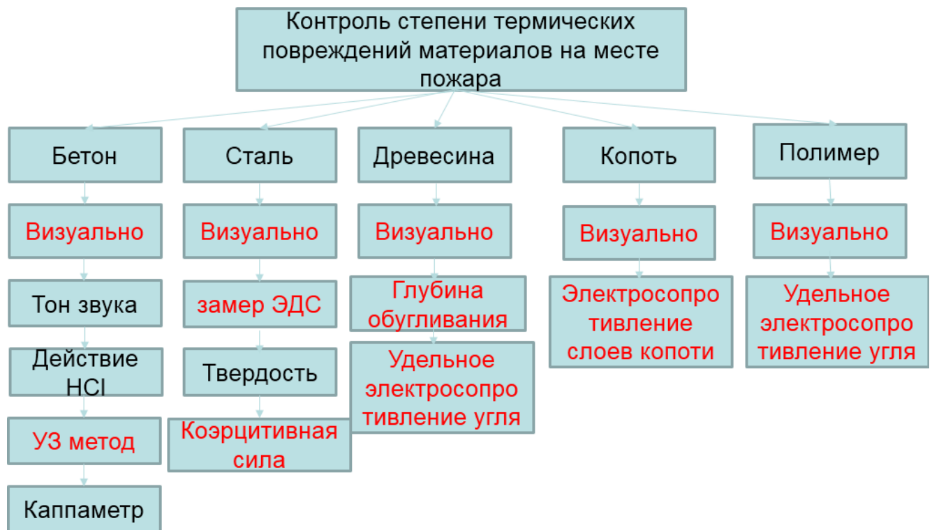
Рисунок 1.2 – Методы контроля степени термических повреждений на месте пожара
