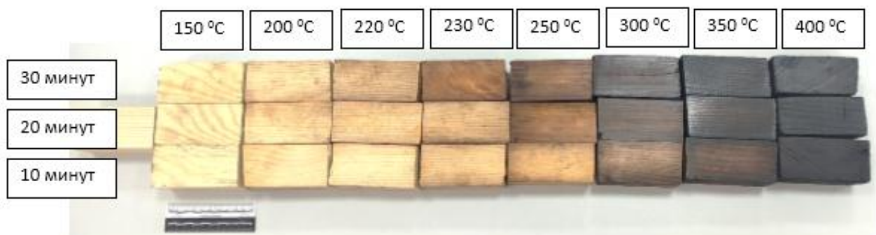
Рисунок 3.23 – Вид образцов древесины после термического воздействия
