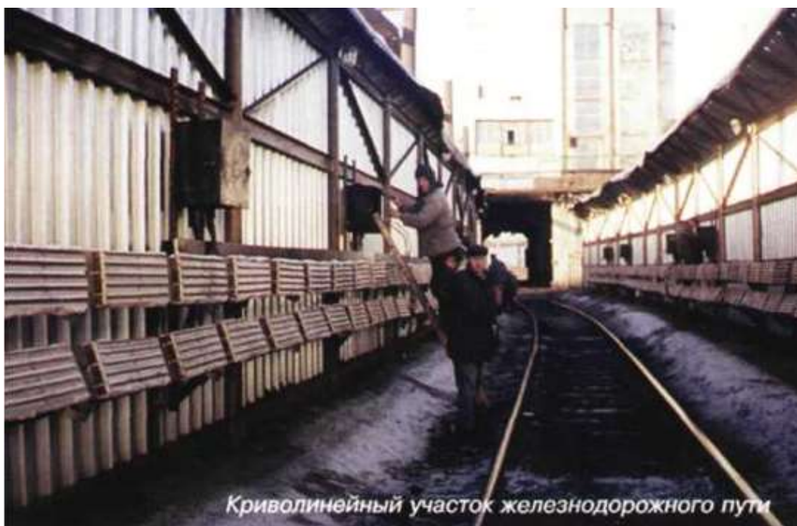
Рис. 1.19. Сопряжение размораживающее устройство "Инфрасиб" с вагоноопрокидывателем
