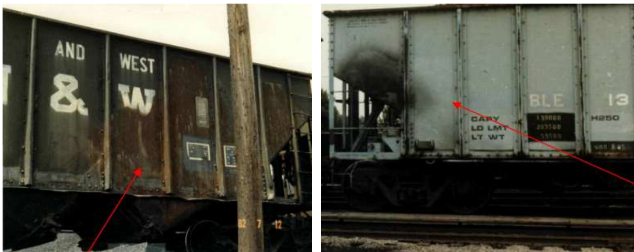
Рис.1.22 Повреждению вагонов после разогрева в инфракрасных газовых нагревателях
