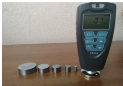
Рисунок 4.10 – Образцы оснований различных диаметров
