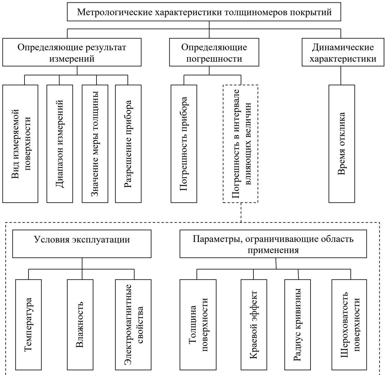
Рисунок 1.5 – Схема метрологических характеристик и влияющих величин
