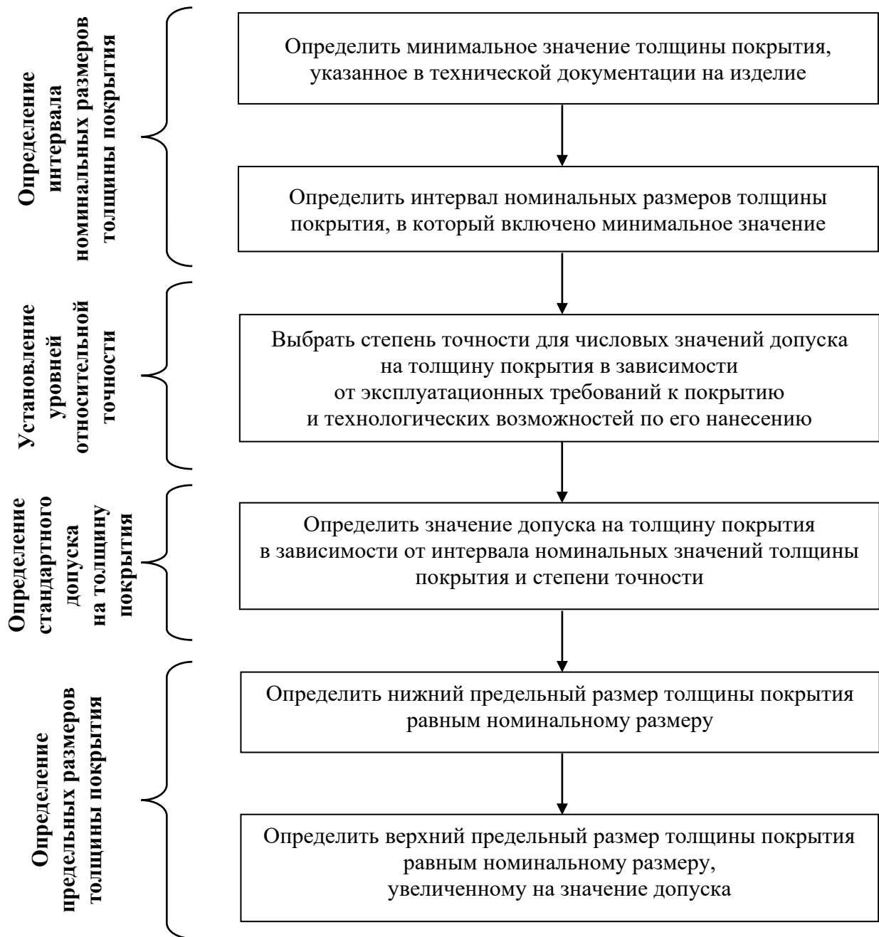
Рисунок А2 – Порядок определения допусков на толщину покрытия
