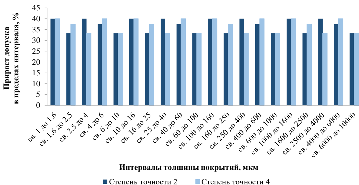
Рисунок 2.3 – Прирост допуска на толщину покрытий по интервалам
