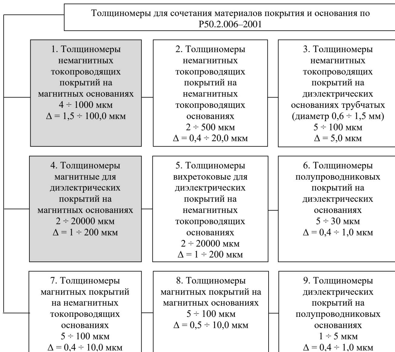
Рисунок 1.3 - Рабочие средства измерений по поверочной схеме Р50.2.006-2001
