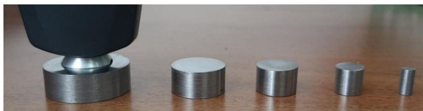
Рисунок 4.12 – Нулевая калибровка по основанию диаметром 40 мм
