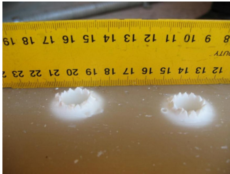
Рисунок 2.16. – Отпечатки, оставленные коническим наконечником твердомера на парафиновом образце – вид под углом
