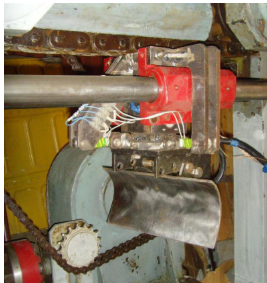
Рисунок 3.28. – Тензометрический элемент ИП-2 для контроля силы сопротивления разрушению твердых сред масштабными моделями отвальных рабочих органов в сборе
