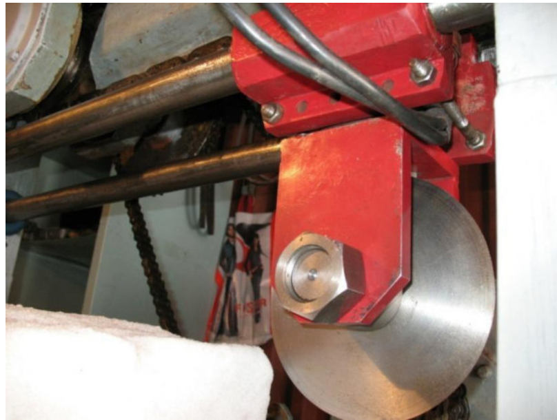
Рисунок 3.8. – Тензометрический элемент в сборе с кронштейном и режущим инструментом, установленный на лабораторном стенде
