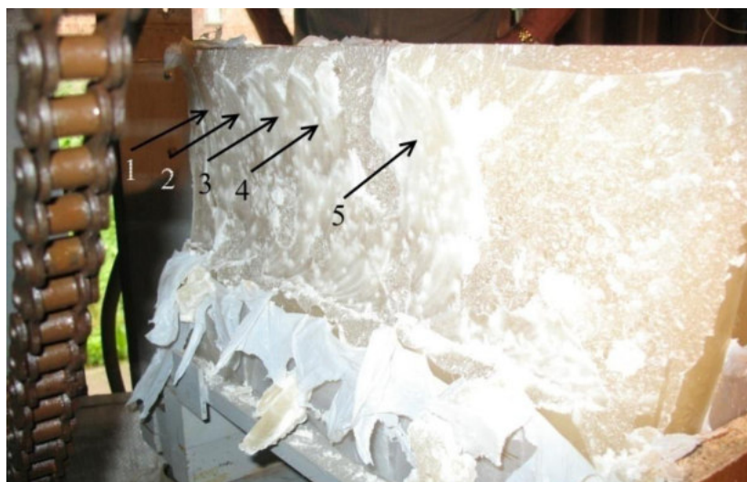
Рисунок 4.5. – Результаты разрушения вертикальной стенки парафинового блока дисковым резцом, установленном на Г – образном кронштейне: 1 – 5 – зоны уплотнения разрушаемого материала
