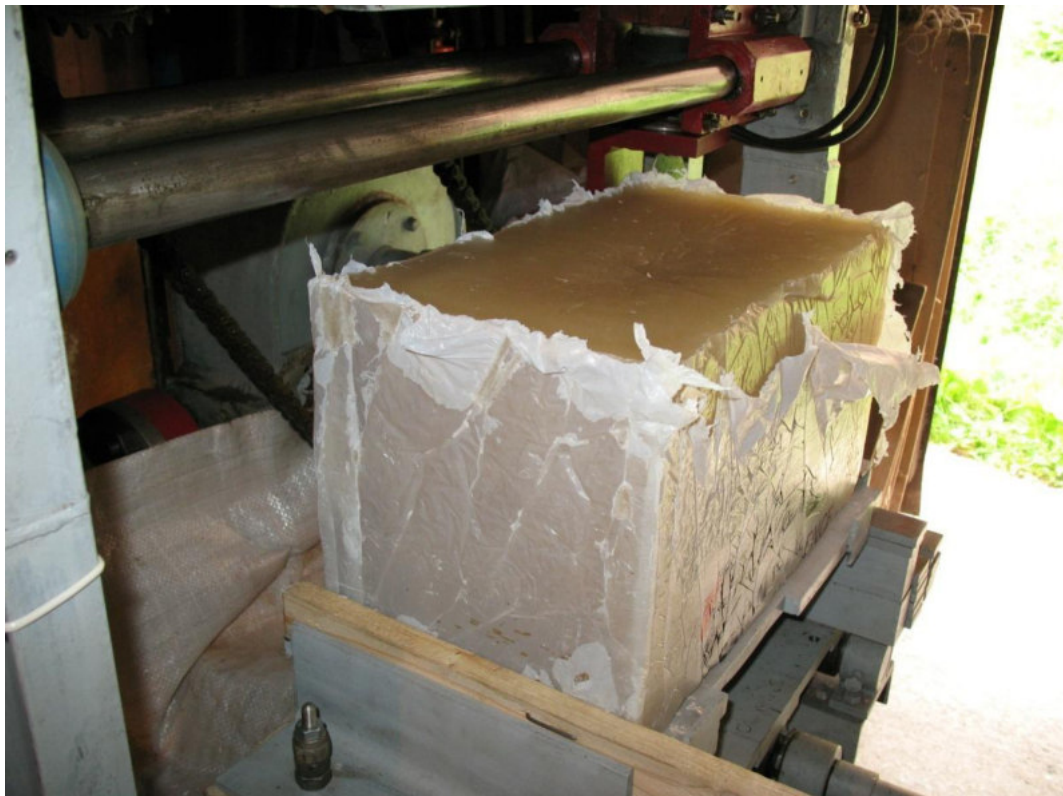
Рисунок 4.1. – Лабораторный образец разрушаемой среды, изготовленный из парафина Т - 2
