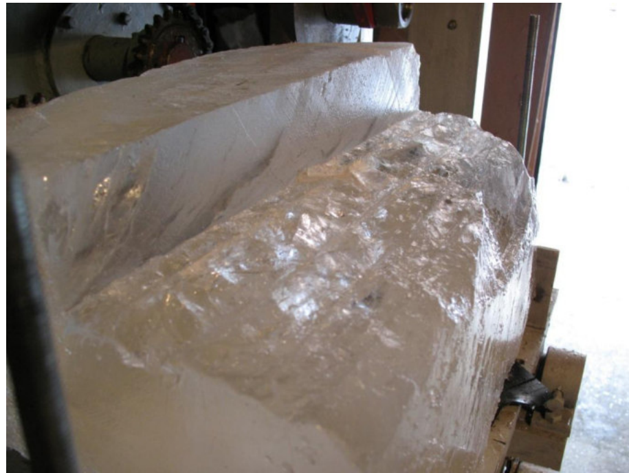
Рисунок 4.16. – Вертикальная стенка уступа (плоскость разрушения) при резании льда дисковым резцом с углом \delta = 30^\circ
