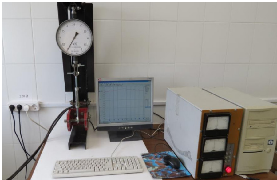
Рисунок 3.32. – Градуировка тензометрического элемента ИП-1 по горизонтальной составляющей измеряемой силы
