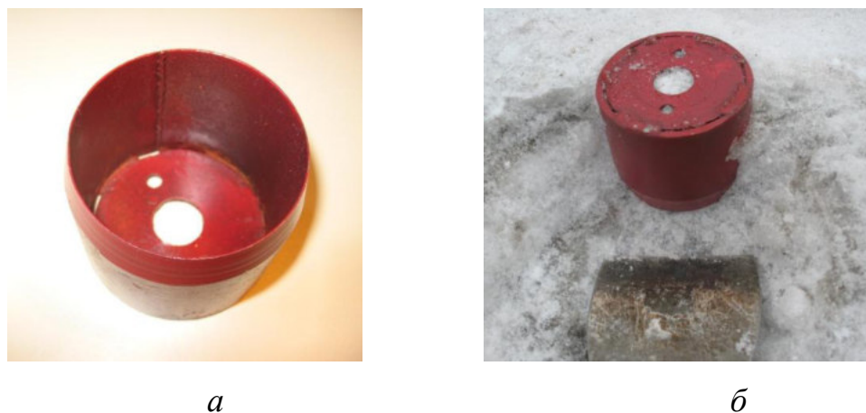
Рисунок 1.8. – Мерный стаканчик плотномера: а – внешний вид; б – отбор пробы уплотненного снега
