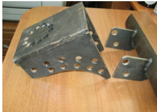
Рисунок 3.27. – Дополнительный П-образный кронштейн тензометрического элемента
