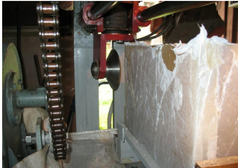
Рисунок 4.4. – Тензометрический элемент ИП – 1 в сборе с Г – образным кронштейном и дисковым резцом, установленный на лабораторном стенде накануне первого пробного опыта
