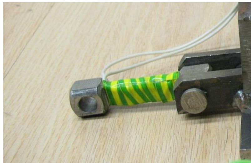
Рисунок 3.25. – Тяга тензометрического элемента, воспринимающая воздействие от боковой составляющей силы сопротивления резанию
