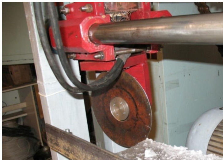
Рисунок 3.16. – Крепление тензометрического элемента ИП-1 в сборе с кронштейном и режущим инструментом на лабораторном стенде
