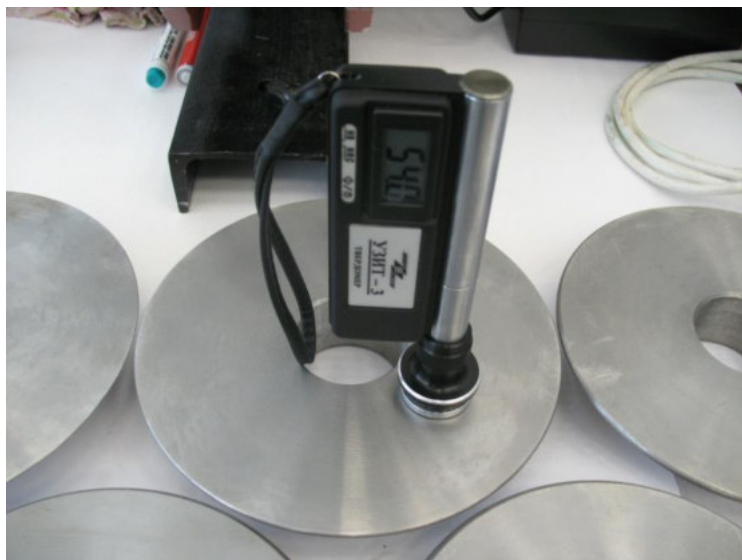
Рисунок 4.3. – Измерение твердости материала дисковых резцов твердомером УЗИТ - 3
