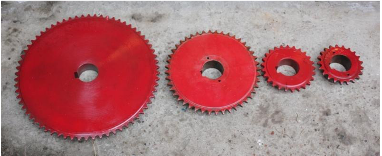
Рисунок 3.9. – Звездочки к приводным роликвым цепям, использующиеся в конструкции модернизированного стенда
