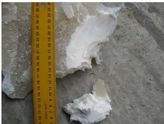
Рисунок 4.6. – Часть фрагмента разрушения лабораторного образца со следами воздействия режущего инструмента и сопрягаемых с ним элементов
