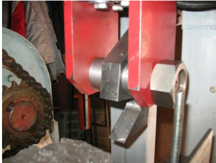
Рисунок 3.20. – П – образный кронштейн в сборе с экспериментальным образцом зуба землеройной машины
