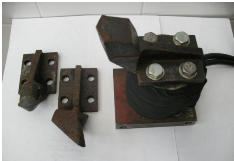
Рисунок 3.21. – Масштабная модель зуба землеройной машины, установленная на тензометрическом элементе
