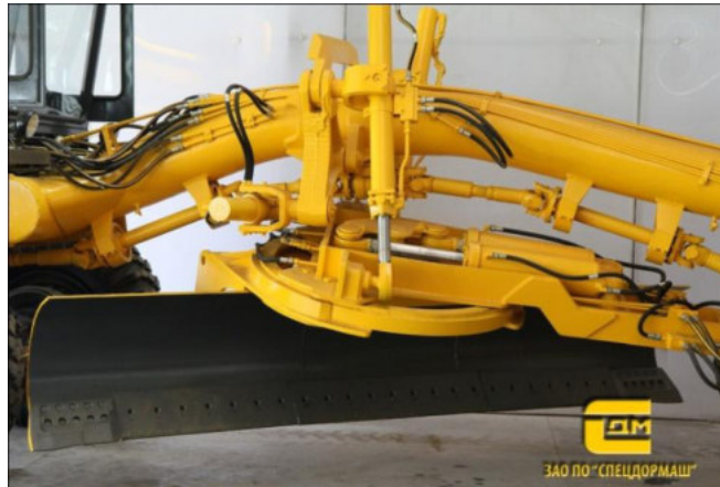
Рисунок – 1.15. Отвал автогрейдера ДЗ-98 с ножом из сменных стальных пластин
