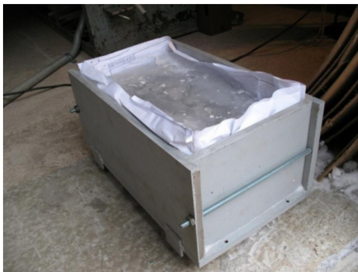
Рисунок 3.6. – Металлическая разборная форма для приготовления лабораторного образца разрушаемой среды
