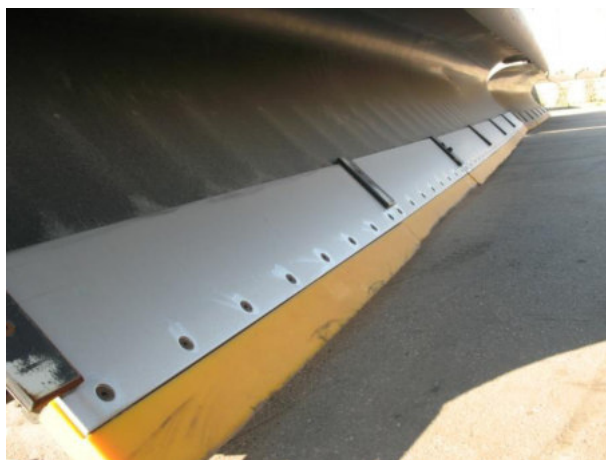
Рисунок 1.14. – Скоростной углепластиковый отвал аэродромной уборочной машины Vammas PSB 5500H с эластичным ножом длиной 5,5 м
