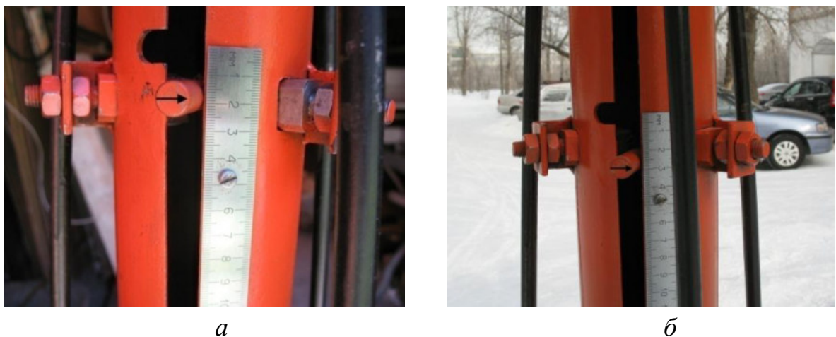
Рисунок 2.17. – Определение глубины погружения конического наконечника в исследуемое покрытие по шкале мерной линейки твердомера: а – на парафиновой пробе; б – на уплотненном снегу
