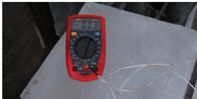
Рисунок 4.11. –Измерение температуры внутри массива ледяного блока цифровым мультиметром с термопарой
