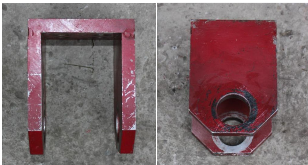
Рисунок 3.17. –Внешний вид П – образного кронштейна, несущего полноразмерный режущий инструмент
