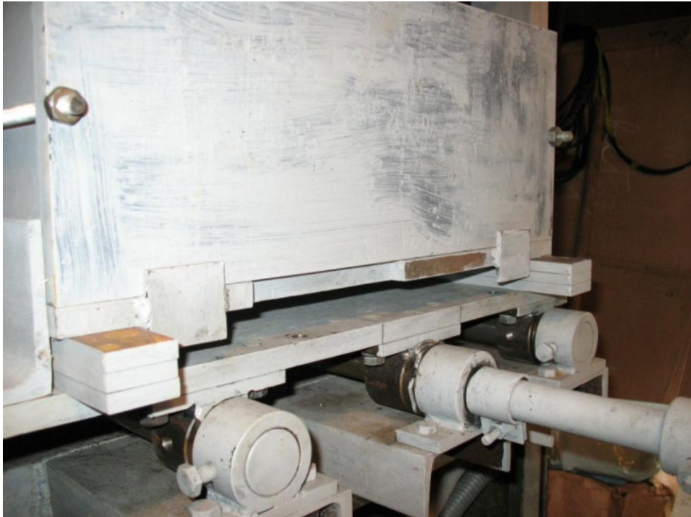
Рисунок 3.7. – Металлическая разборная форма, установленная на несущей плите МППО лабораторного стенда на калиброванных пластинах для регулировки глубины резания
