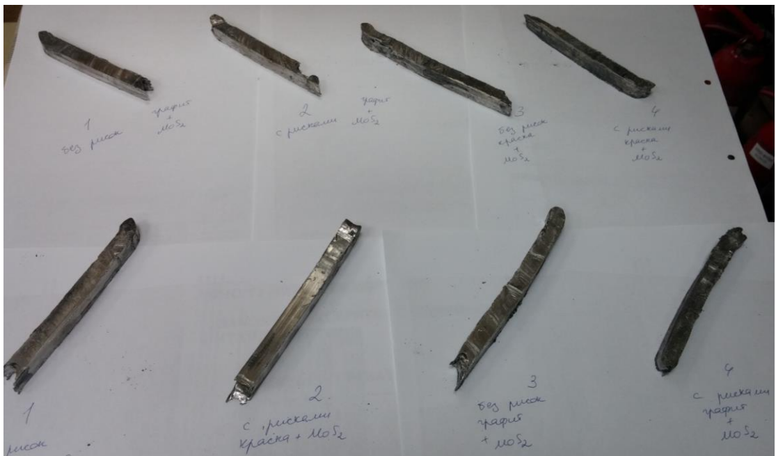
Рисунок 4.7 – Образцы № 1-4, полученные после обработки Мульти-РКУП-К: верхний ряд - при 150 °С; нижний ряд – при 170 °С
