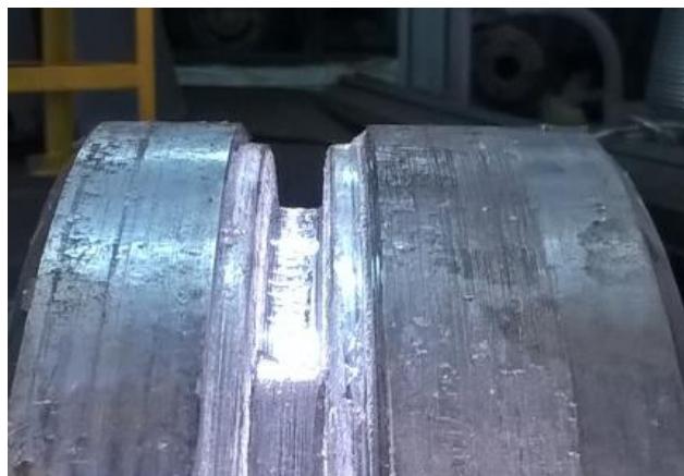
Рисунок 4.18 – Общий вид профиля гравюры рабочего колеса варианта оснастки №2
