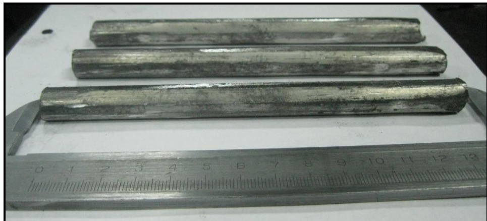
Рисунок 4.5 – Исходные заготовки Al 6101 без рисок
