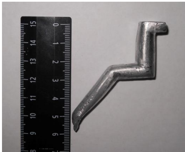
Рисунок 1.10 – Экспериментальный образец после СЛиПП-РКУП [48]
